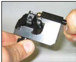
5 5 - Utilizzando un cacciavite od un barretta per chiavi a tubo avvitate il pomello
