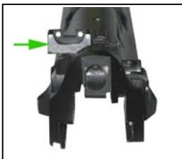
7 7 - Infilate la tacca di mira nella sede sull'otturatore. Il montaggio della mira deve essere sempre eseguito da sinistra come indicato nella foto 7 - The rear sight has to be inserted on the slide. The installation has to be performed from the left side of the slide as indicated in pic. 7
