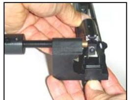
8 - Svitare il pomello laterale. Procedere come ai punti 1 e 2. Il pomello laterale deve essere a sinistra dell'otturatore - Unscrew the side Knob. Follow the operations as phase 1 and 2. The side Knob has to be on the left side of the slide
