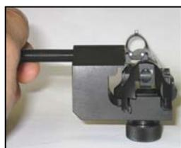
9 9 - Utilizzando un cacciavite od un barretta per chiavi a tubo avvitate il pomello
