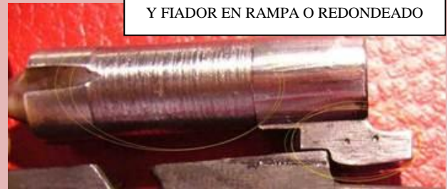
PUNTO DE RETENIDA ENTRE PERCUTOR Y FIADOR EN RAMPA O REDONDEADO
