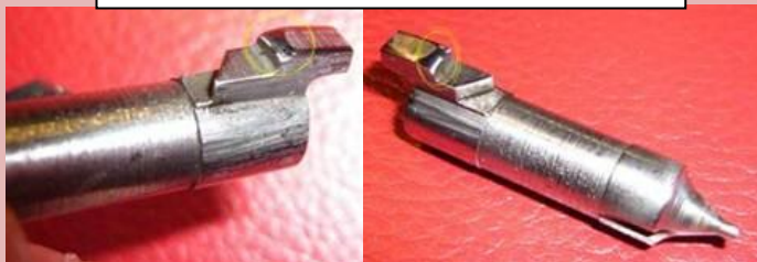
PERCUTOR CON RETENIDA DESGASTADA, O INADECUADAMENTE RETOCADA
