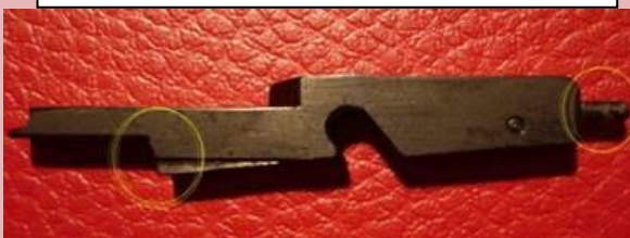
FIADOR CON ANGULO RETEN PERCUTOR INDEBIDO Y PULSADOR INCORRECTO
