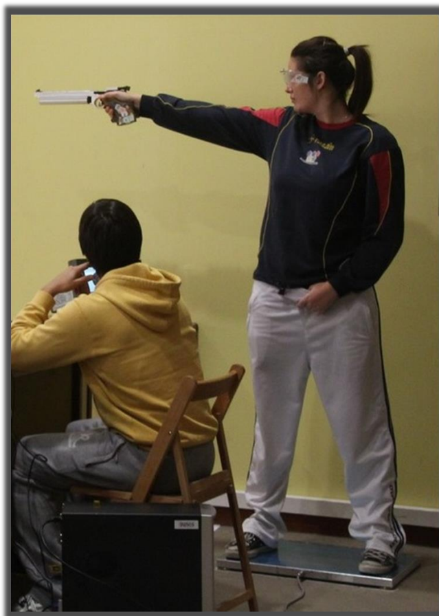
Figura 20. Tirador realizando la prueba de equilibrio con pistola sobre plataforma modelo Kistler 9286AA.
