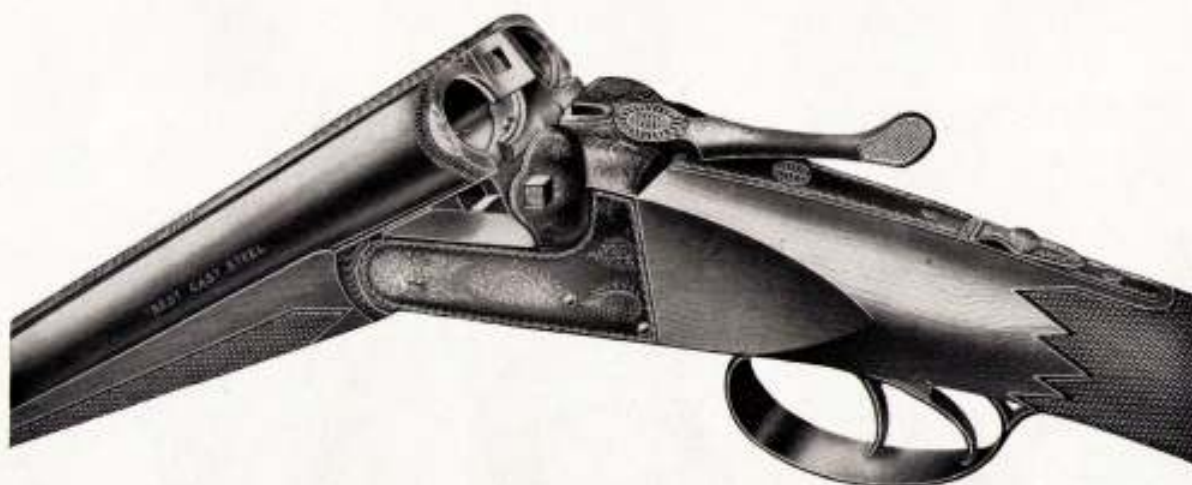
MODELO 155. —Calidad "Trust-Extra" - SOLID-BLOK , elegantísima presentación, construída con acero "Best Cast Steel" cañones de 65 o 70 centímetros de largo, izquierdo full-choke y derecho choke , tres enganches con pasador cuadrado, orejas de refuerzo, canales para escape de gases, culata de nogal fino con pistolet Pieper, de fácil manejo y encare, recomendable para batidas, con cuatro pruebas para gran cartucho. Pesetas 190,—
