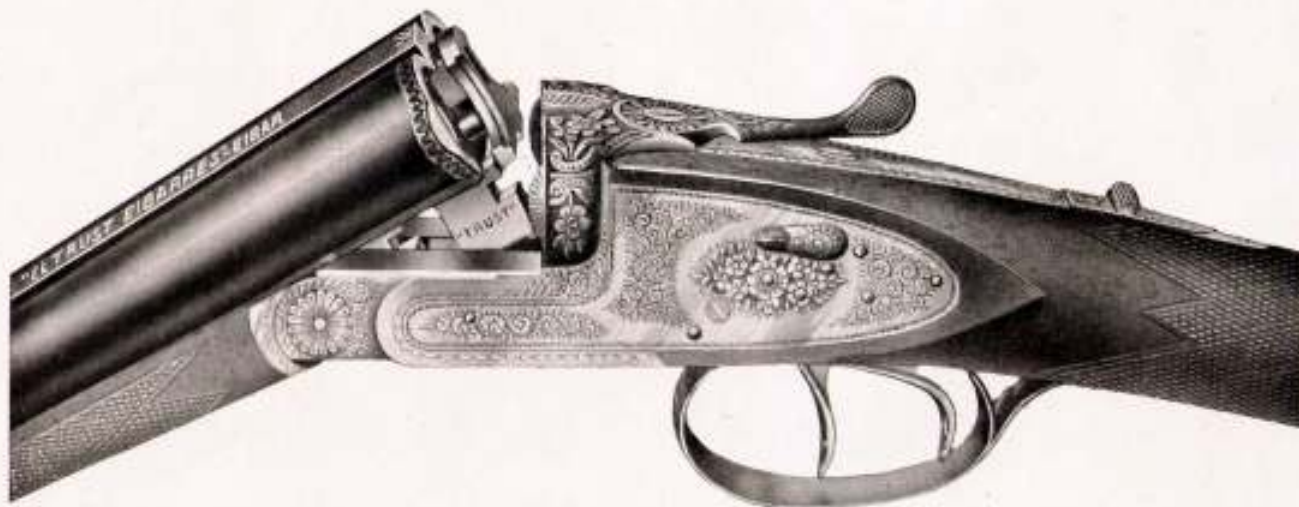
MODELO 194. —"TRUST-EXTRA" escopeta Hammerless de dos tiros, cañones de acero especial, ambos choke-bored , banda fina, triple cierre PURDEY incrustado en la báscula, extractores doble radio HOLLAND, llaves finas de retroceso con doble seguro y desarme a mano encajadas en la báscula, culata de nogal escogido y superiormente cuadrillada. Un fino grabado remata la escopeta elegantemente. Garantizada con 4 pruebas; recámara de 70 m/m. para cartucho largo. Pesetas 317,50
