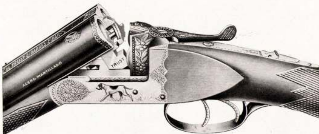
MODELO 157. —Hammerless de dos tiros, movimiento oculto ANSON-DEELEY, con seguro automático, triple enganche PURDEY legítimo, báscula con encajes en la culata y refuerzos laterales, cañones de acero martillado sistema SOLID-BLOK izquierdo choke , recámara de 70 m/m. probada y garantizada para pólvoras sin humo. Pesetas 185,—
