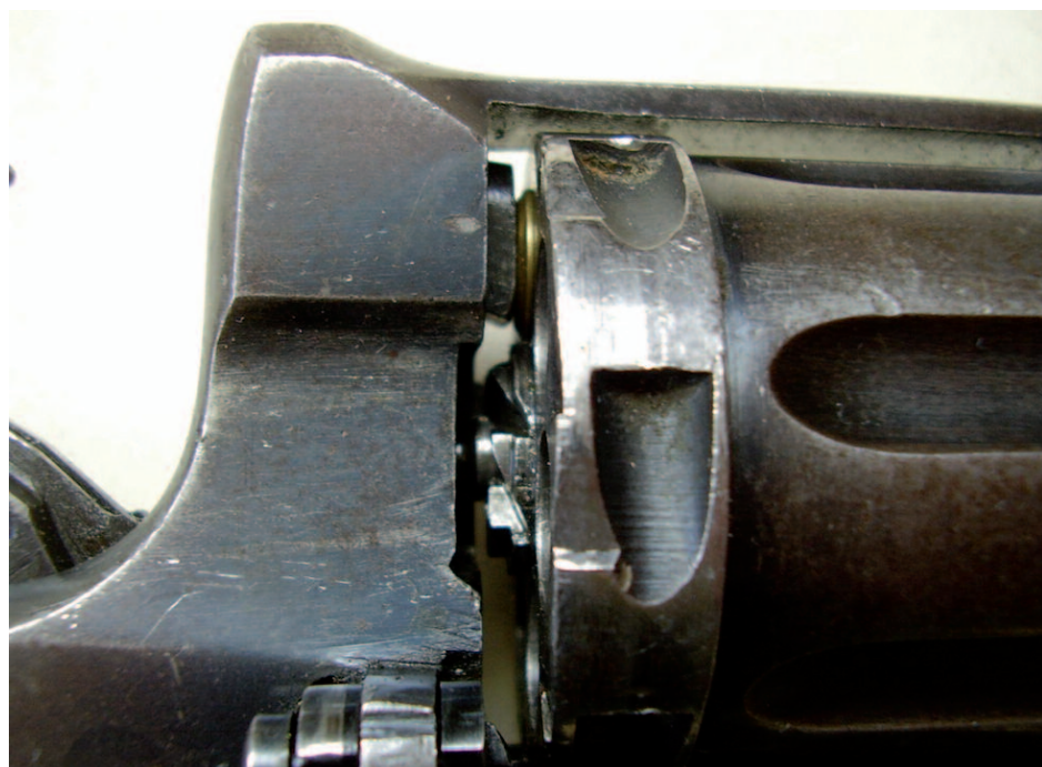
►► Vue de la pièce de culasse appuyant sur le culot de la cartouche
