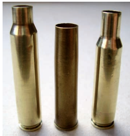
►► Cartouche Nagant origine entre une douille de 223 R et une douille de 222 R
