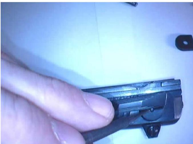
Una vez comprimido el muelle sacamos esta hacia abajo (puede costar algo de trabajo comenzar el desplazamiento y nos podemos ayudar con el mango de la baqueta o un destornillador).
