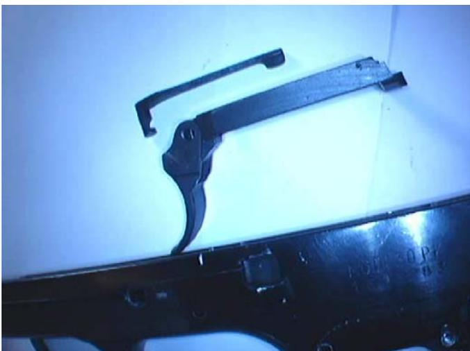
Para desmontar la retenida del cargador usaremos la punta de la baqueta o un destornillador fino
