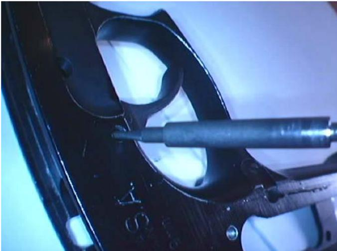
Con la punta de un destornillador extraemos el seguro de cargador hacia arriba (los modelos 28 no tienen seguro de cargador)
