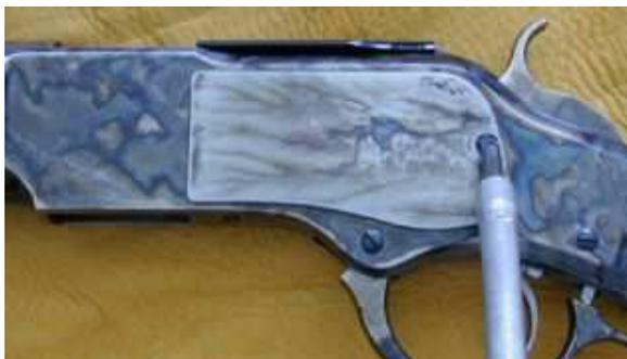
Levantar el arma ligeramente y la tapa derecha caerá en la mesa por su propio peso junto con el “Link” derecho y probablemente el pasador de la palanca.
