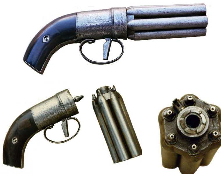
PIEZA N° 1962-1384: Avispero tipo Herman, inscrito " Reformado por Manuel Garate, en Eybar ". Seis cañones, longitud 91 mm, para bala forzada, con 11 mm de diámetro de ánima.
