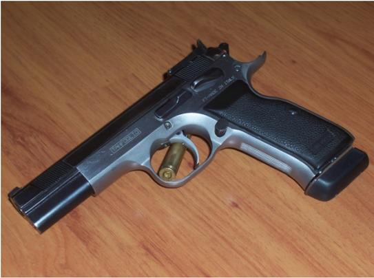
1 Comenzamos el desmontaje comprobando en primer lugar si el arma está vacía y descargada para lo que sacamos cargador y tiramos de la corredera hacia atrás.
