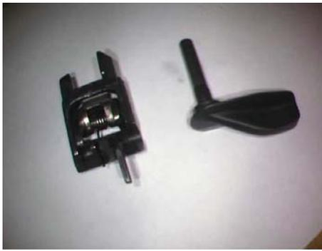
12 En el siguiente paso con un botador sacamos el eje del disparador presionando desde la derecha del arma, sin necesidad de sacarlo del todo se extrae el disparador con su biela y el muelle del disparador.
