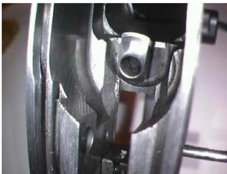
Esta pistola está pensada para tirar solo en SA en las que están pensadas para DA no es necesario desmontar el grupo de disparo y el disparador para sacar el elevador de la biela (por ejemplo si queremos cambiar de lado el pulsador de la retenida del cargador), solamente es necesario girarlo 180° con un alicate de puntas y tirar de él hacia arriba.
