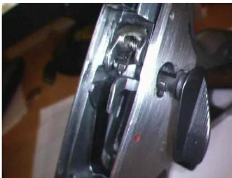
10 Una vez retirado el eje del seguro se puede sacar el mecanismo de disparo tirando de el un poco hacia adelante y hacia abajo hasta que se suelte de la biela del disparador y de las guías del armazón.
