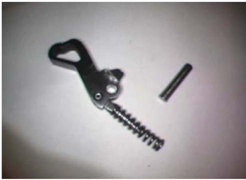
16 Ya solo nos queda sacar el eje del fiador y retirar el fiador con su muelle.
