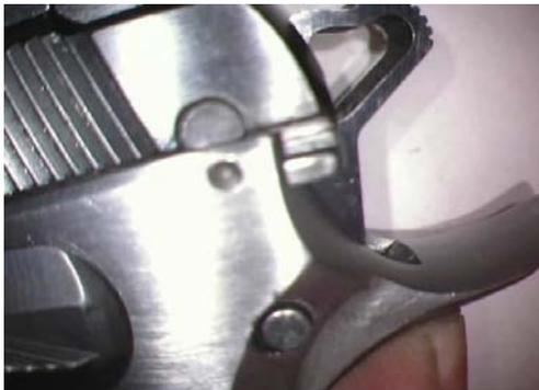
3 En esta posición sujetando la corredera y el armazón con una mano presionamos con la otra el extremo del eje de la retenida del cargador (si está muy duro se puede presionar con la base del cargador).
