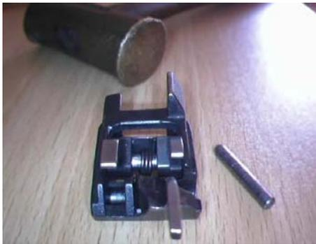
Para montar la retenida del seguro se introduce un botador por el orificio que lleva para presionar el pitón con muelle al mismo tiempo que se introduce el elevador de la biela, una vez que está presionando contra el botador se retira este sin dejar de hacer presión en el elevador de manera que se introduce delante del pitón.
