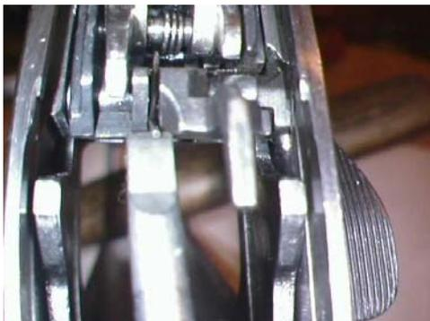
9 A continuación sacamos la aleta del seguro con su eje, algunos modelos llevan una bola con un muelle para fijar la posición del selector del seguro, en el caso de este modelo, esa bola va fija y no se pierde.
