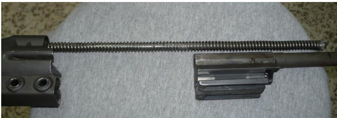
A partir de esta distancia, si seguimos apretando, debe empezar a comprimir el muelle, y por la otra punta asomar solo el guía, pero no muelle. En una ocasión cambié este anillo por uno metálico original de Cetme, y así ni limar ni ajustes ni nada, lo cambias y listo, pero hay que tener ese casquillo que será lo difícil.
