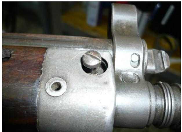
Primero aflojamos a tope, y cuando esté suelto tiramos de él con los dedos hacia afuera y volvemos a girar hacia izquierdas para desenroscar la segunda parte, esto es porque las dos chapas que tiene el guardamanos tienen rosca, y debe salir así, fijaos bien cuando esté desmontado y lo entenderéis fácilmente.
