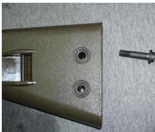
Ahora quitamos los dos tornillos secundarios, que se encuentran por la parte delantera de la culata, y sujetan el buffer al chasis y culata, de esta forma sacamos el buffer y tirando separamos la culata de plástico del conjunto chasis-muelle.
