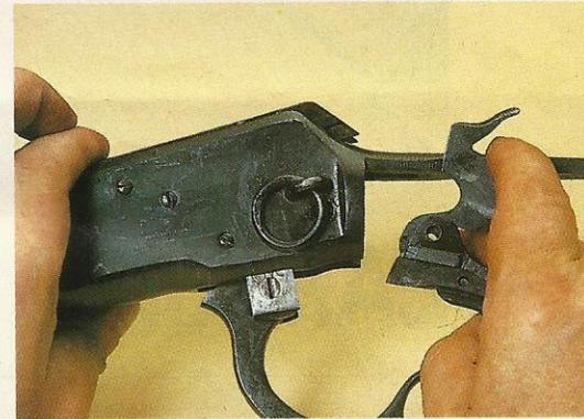
**8.** Libre de tensión, sacamos el tornillo-eje del martillo, y retiramos éste por debajo, junto con el gatillo y su alojamiento que deslizamos hacia atrás.
