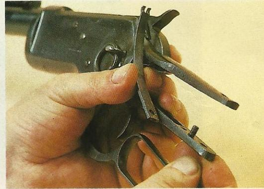
**7.** Para desarmar la acción, abrimos la palanca, desenroscamos el tornillo que sujeta el muelle real y lo quitamos.
