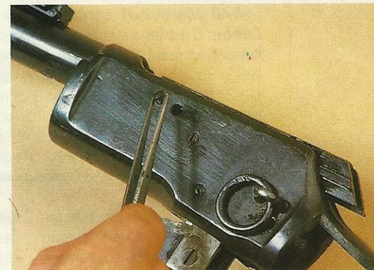
**9.** Desenroscamos el tornillo que cubre el pasador que une la palanca al cerrojo, sobre el lado izquierdo del cajón de mecanismos.
