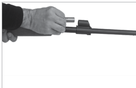
Sl. 11 Odvajanje regulatora barutnih gasova
