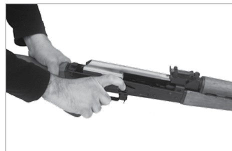
Sl. 8 Vađenje nosača zatvarača sa klipom
