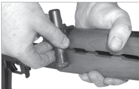
Sl. 10 Odvajanje gasnog cilindra
