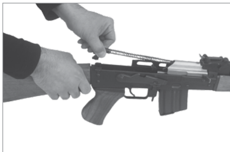
Sl. 7 Odvajanje povratnog mehanizma
