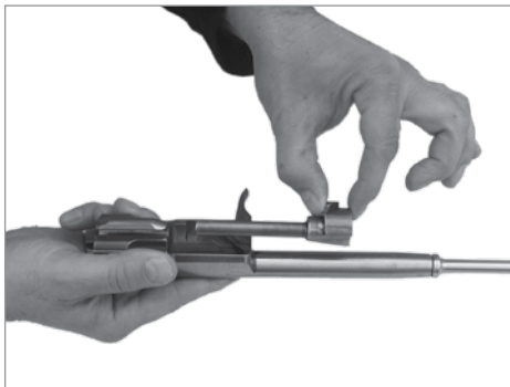
Sl. 9 Odvajanje tela zatvarača od nosača zatvarača
