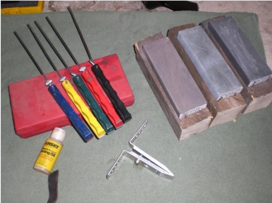
El primero de los sistemas de tornillo es el sistema Lansky, que se basa en una guía que va sujeta en un tornillo de banco...En esta guía, anclamos el cuchillo, y luego, con las varillas que tienen las piedras, le vamos dando según el grado que deseemos...se puede dar una inclinación de 30,25,20 y 17 grados respectivamente...Por mi experiencia, y siguiendo los consejos de Angel, unos 25 grados son la unión de un filo duro, y cortador...
