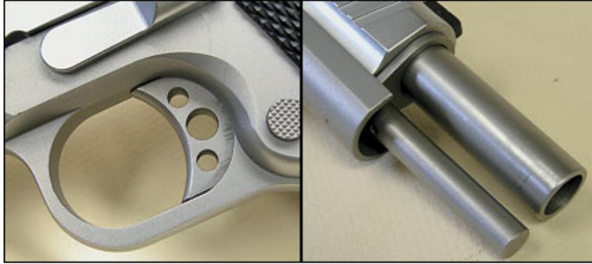
La pistola está provista de una guía de resorte extendida, sólida y tope delantero abierto del resorte recuperador, el seguro de pulgar es de estilo competición/combate, extendido y ambidiestro, el seguro de empuñadura es del tipo de cola de castor e incorpora una saliente en su parte inferior para asegurar su accionamiento positivo cuando se deba empuñar el arma en forma imperfecta, según las circunstancias de uso.
