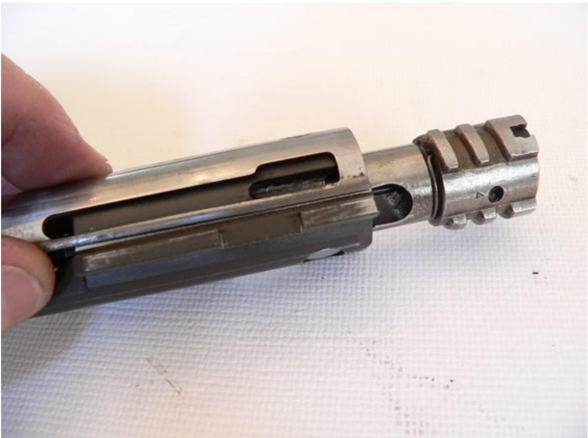
**18 y 19.-** Después de limpiar el cerrojo vamos a volver a montarlo; pero ojo al parche porque para reintegrarlo al cajón de mecanismos necesitaremos que la pieza (26) señalada en la primera foto no sobresalga. Para eso, como vemos en la segunda foto, la cabeza del cerrojo tendrá que estar adelantada. De esa manera, la pieza podrá internarse en el bloque del cerrojo y no impedir su acomodo en el riel correspondiente.
