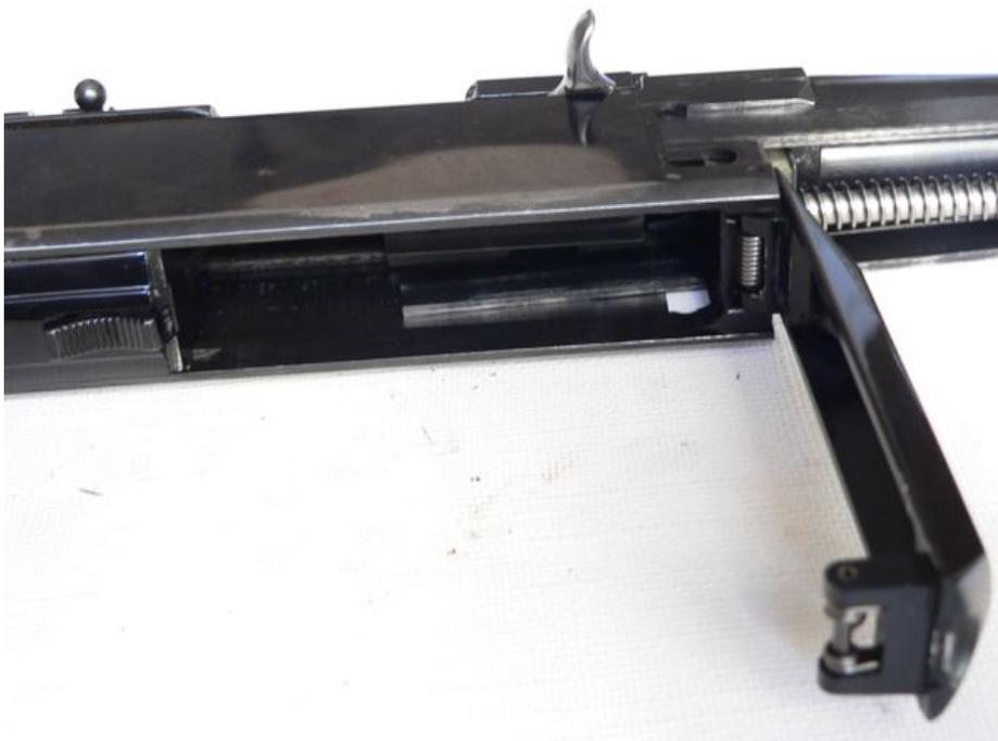
**28.-** Para volver a montar las bielas, las metemos por las ranuras delanteras del cajón de mecanismos y a través de la ventana comprobaremos que sus espigas encajan en los ataches. En la foto, la espiga a punto de entrar en su punto de atache situado en el cerrojo.
