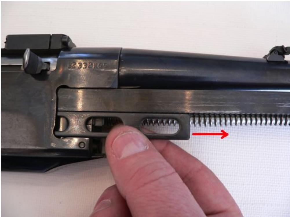
5.- Sacamos las bielas que mueven el cerrojo (12). Al igual que los apoyos guía, tiene una a cada lado del cajón de mecanismos. Para quitarlas, las desalojamos de sus acomodos en el bloque de inercia (9). En el MKII el bloque de inercia es algo distinto, pero se actúa más o menos de la misma forma.
