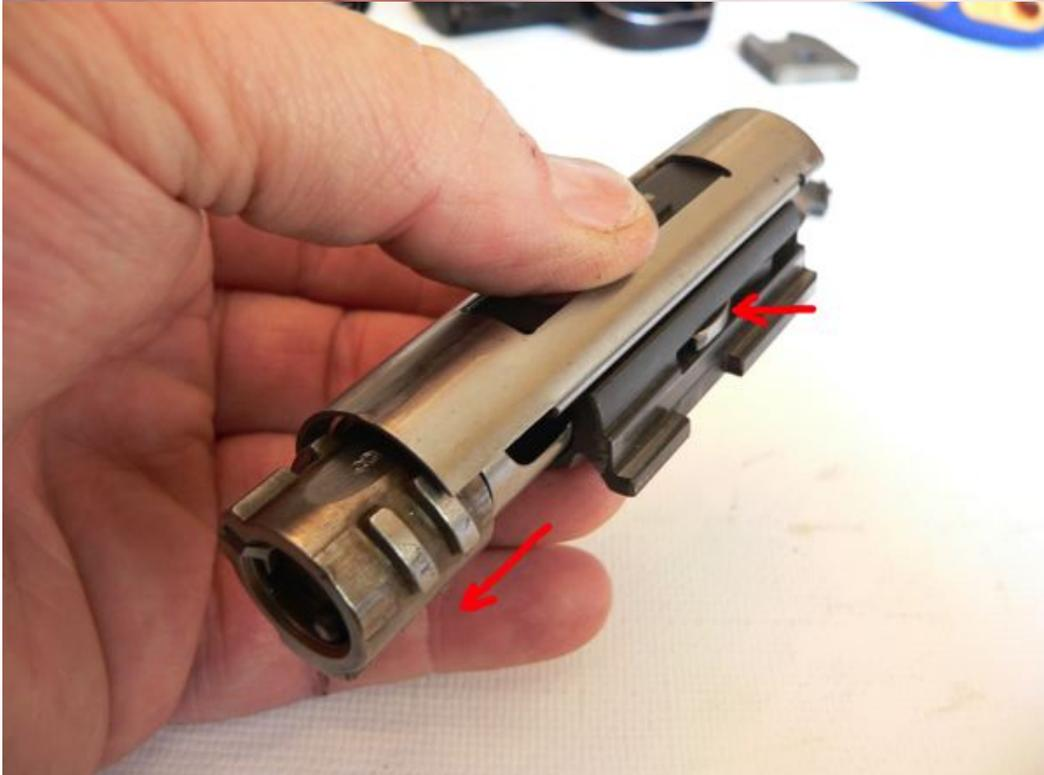
**20 y 21.-** Para reintegrar el cerrojo al cajón de mecanismos, ponemos el cajón (16) boca arriba, apoyamos en él el cerrojo y lo empujamos adelante. Así de sencilla y suavemente volverá a los rieles por los que se desplaza.
