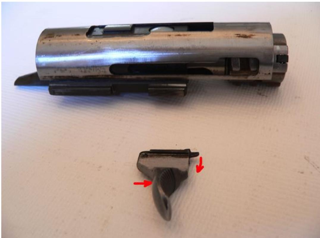
**15.-** Una imagen "macro" del tirador y su espiga y nueva indicación de su movimiento de liberación (movimiento de liberación... ¡Cómo suena eso de raro en el desmontaje de un arma!).
