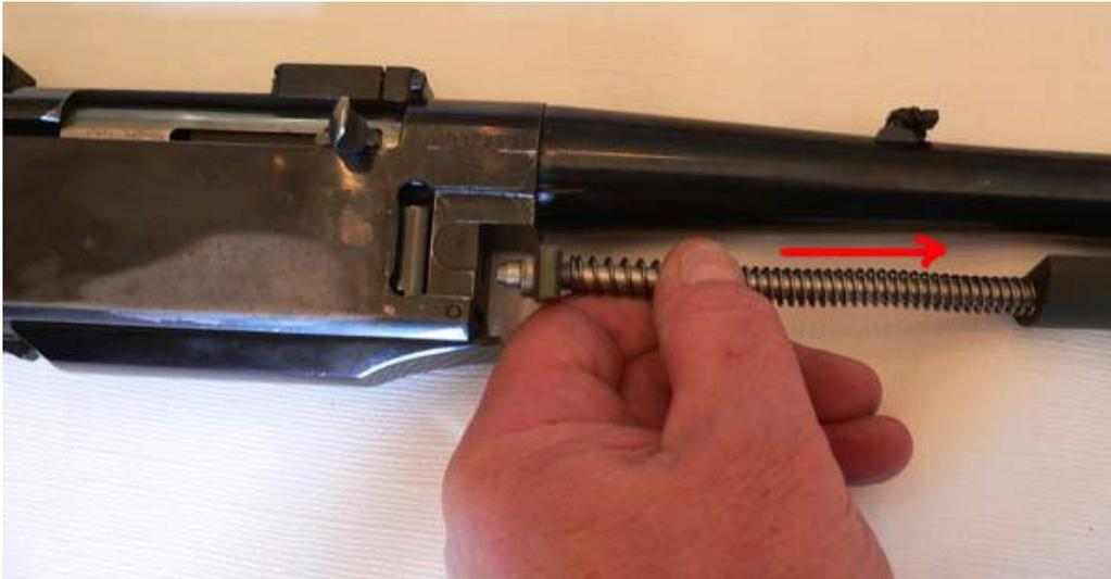
7.- Aquí tenemos desmontado todo el grupo delantero. Aunque la foto no lo recoge, podemos también separar varilla (14), bloque (9), muelle (15) y tope amortiguador sin ninguna dificultad. Este amortiguador está compuesto por dos chapitas (11) y un taquito de teflón entre ellas (10).
