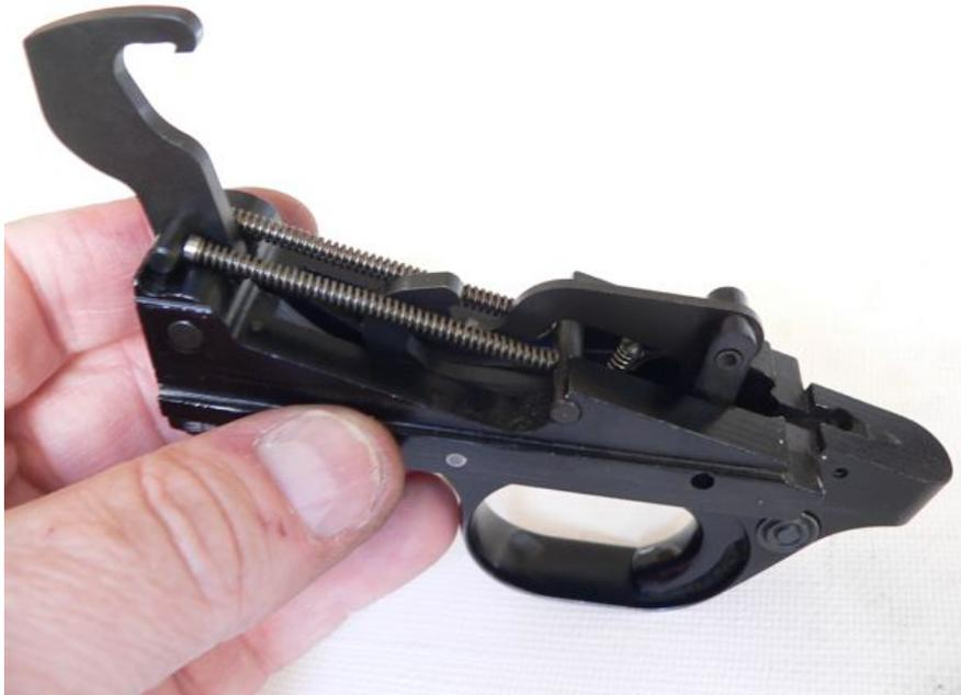
**23.-** Podéis desmontarlo PERO habréis de saber que volver a poner en su sitio el empujador con su muelle que señalo (44 y 45) es un poco puñetero y requiere cierta maña, pues hay que hacerlo teniendo unas piezas montadas y montando otras de forma simultánea.
