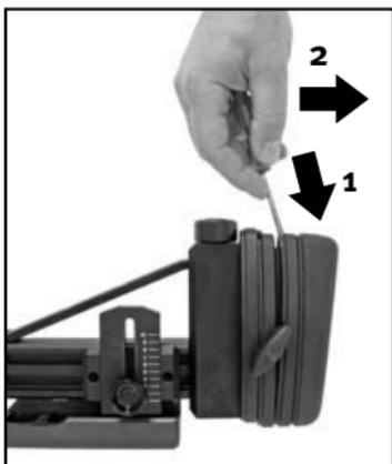
Die Schaftkappe kann durch Abheben mit einer Schraubendreher demontiert werden. Die Schaftlänge kann durch Zwischenstücke individuell angepasst werden.
