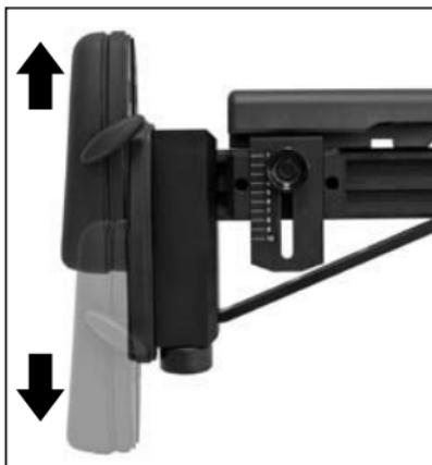
Die Schaftkappe kann in der Höhe an den Schützen angepasst werden. Klemmschraube lösen, Schaftkappe in die gewünschte Position schieben, Klemmschraube festschrauben.
