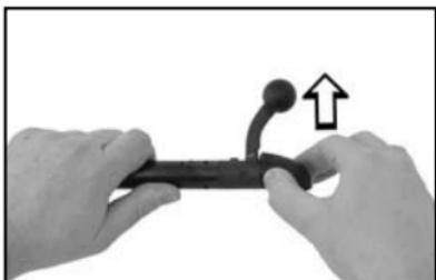
Verschluss in die linke Hand nehmen. Mit dem Daumen der rechten Hand die Sperrklappe hinindrücken und gleichzeitig die Verschlusskappe im Uhrzeigersinn (Pfeilrichtung = Drehrichtung) bis zum hörbaren Entriegeln drehen.
