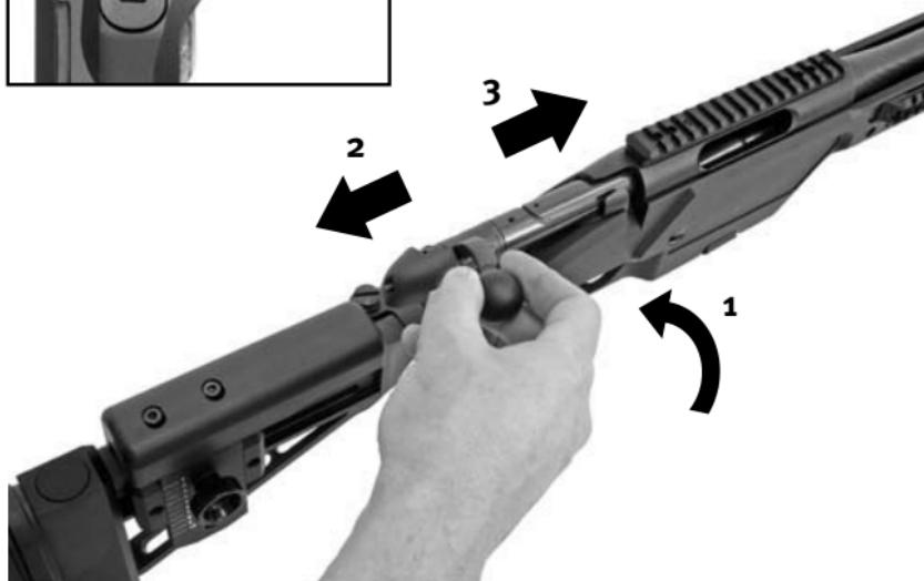
Durch  $70^{\circ}$ -Verdrehen des Kammergriffes nach oben wird der Verschluss entriegelt. Den Verschluss am Kammergriff bis auf Anschlag nach hinten ziehen.
