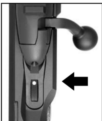
Die gespannte Waffe ist feuerbereit wenn der rote Punkt an der Sicherung sichtbar ist. Das Sicherungsrad ist in vorderster Position.
