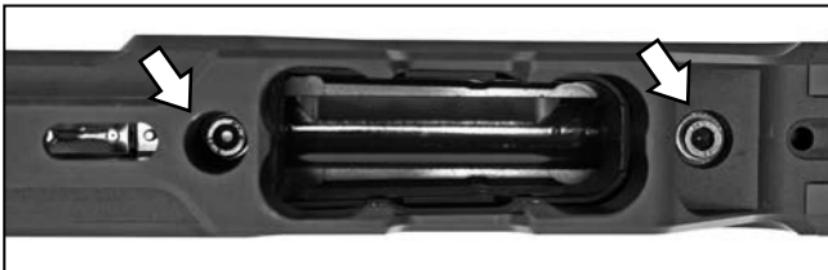
Werden diese Schrauben gelöst, müssen sie mit einem Drehmomentschlüssel ( $7\text{ Nm}$ ) festgezogen werden.
