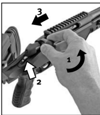
Kammergriff mit der rechten Hand um 70° nach links drehen (entriegeln).
