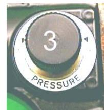
**Nunca** quite una cápsula del gas del CO<sub>2</sub> cuando esta bajo presión. Para vaciar el gas restante: Gire hacia atrás el mando de seguridad y abra la válvula de presión (Presión → Más) y al mismo tiempo apriete el gatillo hasta que salga todo el gas que tiene que escapar y cierre la válvula inmediatamente (Presión → Menos).
