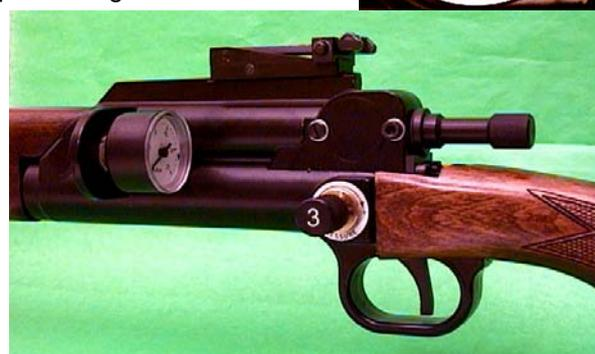
El alza esta insertada en la ranura y se aprieta firmemente con el tornillo. **Nº 1.**
