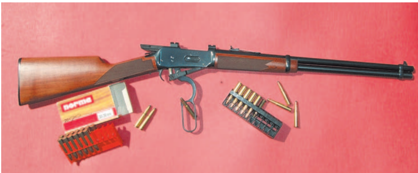
El palanquero Winchester 94 tiene el privilegio de ser el rifle más vendido de la historia de América. Sobre estas líneas, encontramos al modelo 94 AE XTR, una versión con acabados de lujo y con el sistema "Angle-Eject" para la expulsión lateral de las vainas servidas.
