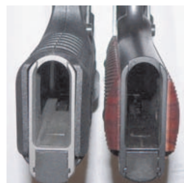
Comparativa del diferente ancho de las cachas originales de una 1911 (derecha) y un modelo con la empuñadura CC3.
