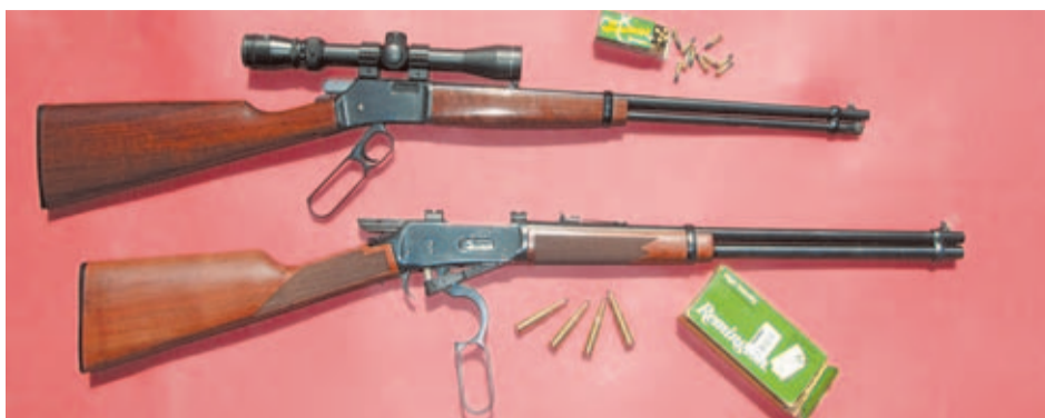
Imagen comparativa entre el Browning BL-22 (arriba) y el Winchester 94. La acción de la carabina Browning del .22lr se abre sólo en 45° y su disparador está integrado dentro de la propia palanca.
