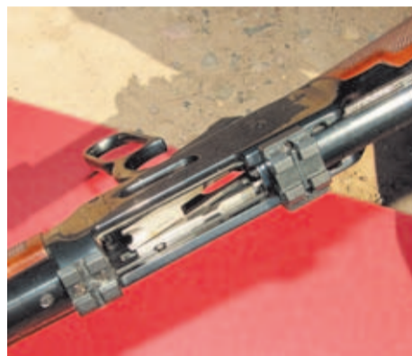
Vista interior de la recámara del 94 AE, con las bases Poli Nicoletta montadas justo encima.
