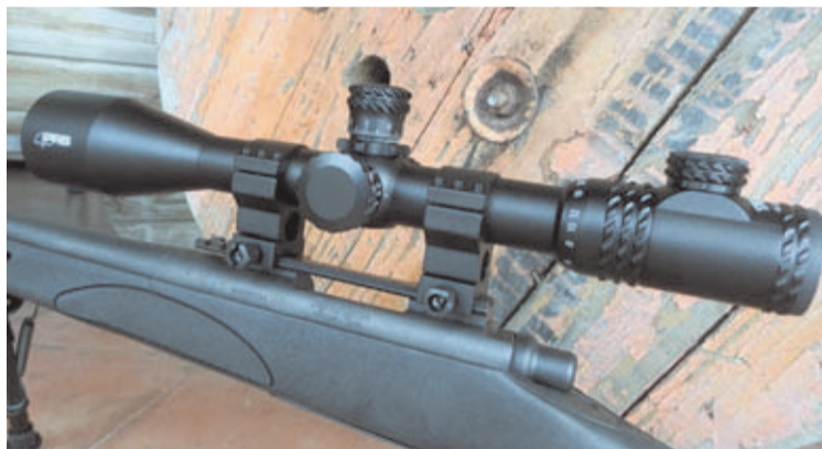
Visor Walther PRS 4-24x50 montado sobre un rifle Remington 700. Las anillas para su instalación van incluidas en el precio del propio visor.
