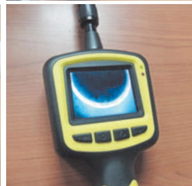
Arriba, la caja de presentación del Top Shot y la micro cámara activada con su luz LED. Abajo, inspeccionando el interior de la recámara de la Ruger 10/22.
