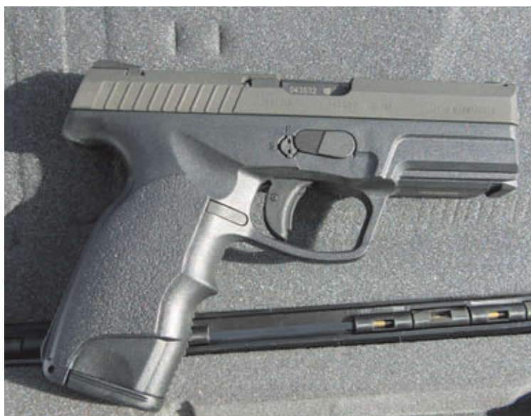
La M9-A1 es una pistola semiautomática de aguja lanzada y armazón de polímero fabricada en Austria en por Steyr Arms. Su diseño cumple 15 años.
