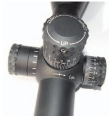
Detalle de las 3 torretas de corrección del Nightforce ATACR. La de altura permite ajustar los impactos hasta en 120 MOA.
