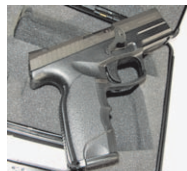
La llave de bloqueo evita que el arma cumpla su ciclo de acción.
