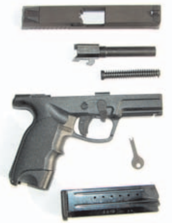
Desarme básico de la Steyr M9-A1. El chasis interno es todo de acero.
