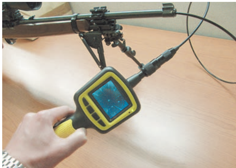
Videocámara Top Shot con el cable endoscópico colocado en el interior del cañón de una carabina Ruger 10/22. El estriado se ve perfectamente.
