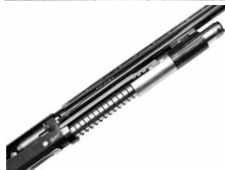
El colector de gases de la MP-153 está formado por 3 piezas que autorregulan su funcionamiento.
