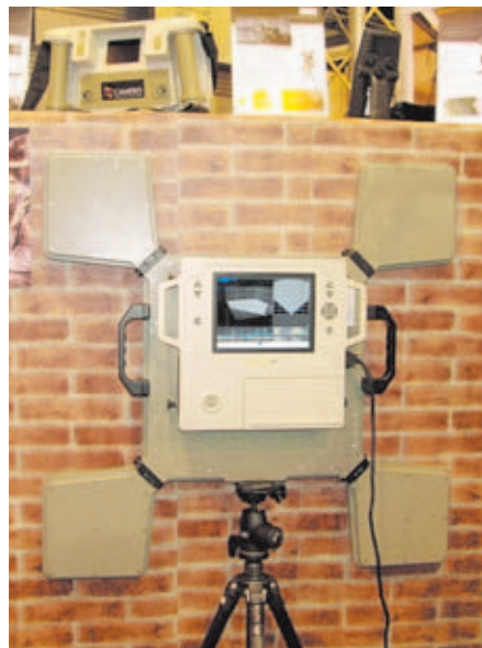
El dispositivo israelí CAMERO permite ver qué sucede detrás de un muro de hormigón.
