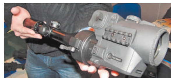
El monocular Pulsar Forward es un visor nocturno de reducido tamaño que se acopla fácilmente a cualquier mira óptica.
