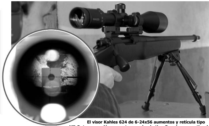
El visor Kahles 624 de 6-24x56 aumentos y retícula tipo Mil-Dot nos ayudó en nuestra prueba de tiro. Para lograr un tiro de precisión a larga distancia es fundamental equiparse con una mira óptica de estas prestaciones.
