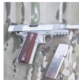
El carril táctico de la nueva Colt Rail Gun permite la instalación de múltiples accesorios.
