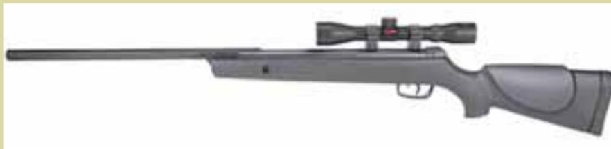
Gamo ha diseñado un nuevo sistema de acción denominado IGT (Inert Gas Technology) que ya se está aplicando en dos de sus carabinas: la Gamo Whisper y la Gamo Stalker. Este nueva tecnología IGT de pistón de gas sustituye al clásico muelle metálico, hasta el momento utilizado en la mayoría de las carabinas de resorte. La principal ventaja de este sistema es que no requiere ningún tipo de mantenimiento, además de que su funcionamiento es totalmente fiable.
