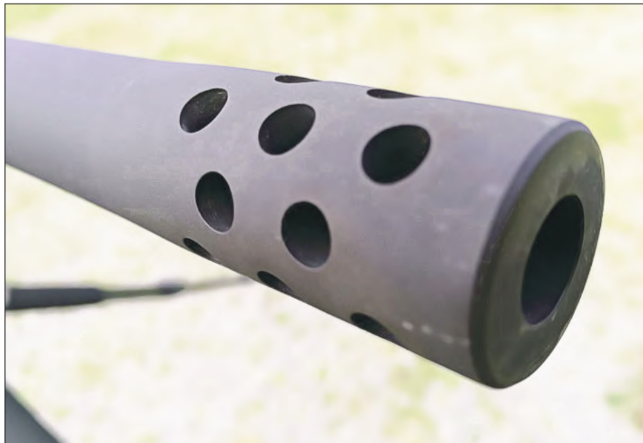
El freno de boca es efectivo pero está integrado en el cañón
