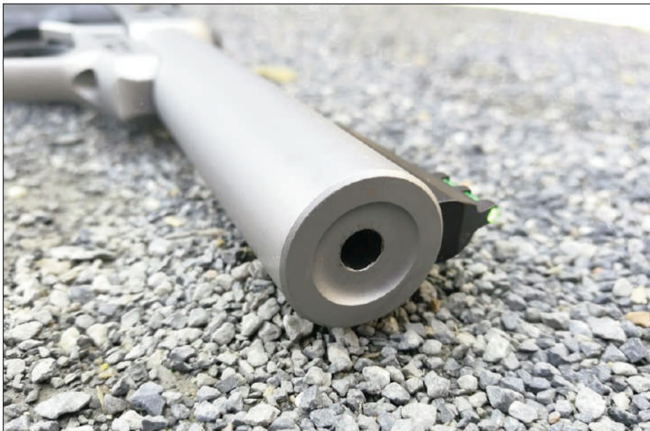
Vista del masivo cañón y la corona de protección
