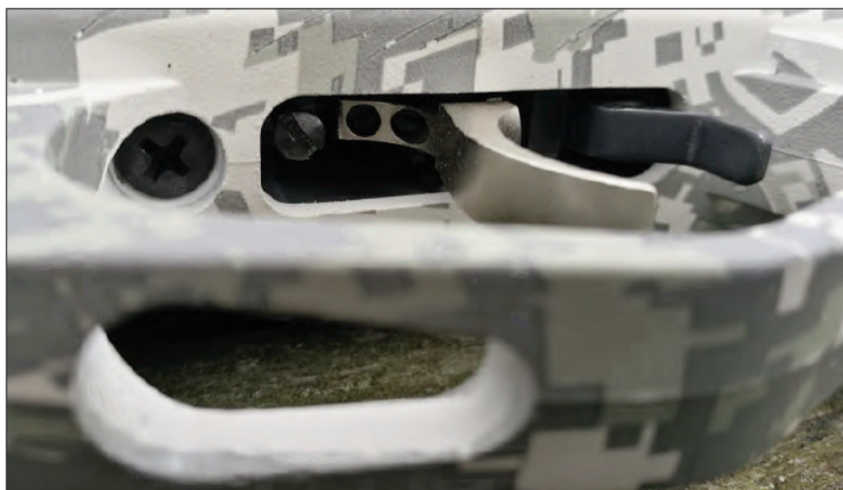
Detalle de los tres tornillos de regulación y el seguro del disparador
