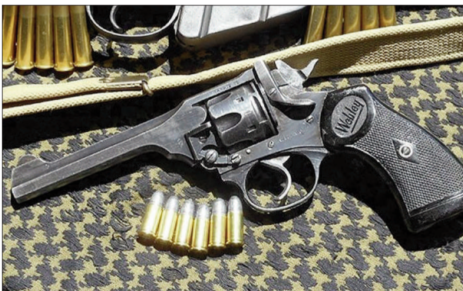
El cambio al cartucho .38 S&W hizo que el revólver fuese mucho más manejable
