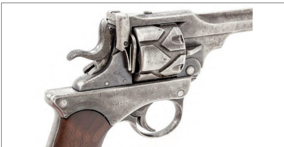
Detalle del cilindro donde se aprecian las acanaladuras que permiten su giro
