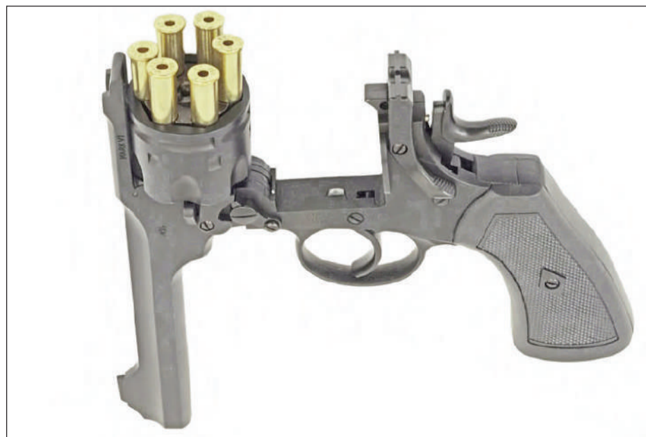
Cuando abrimos el revólver el extractor se levanta del cilindro y presenta los "falsos cartuchos"
