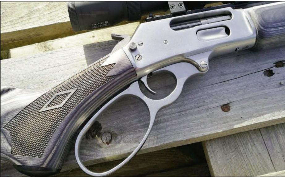
La ventana de expulsión lateral marca la diferencia con otros rifles de palanca
