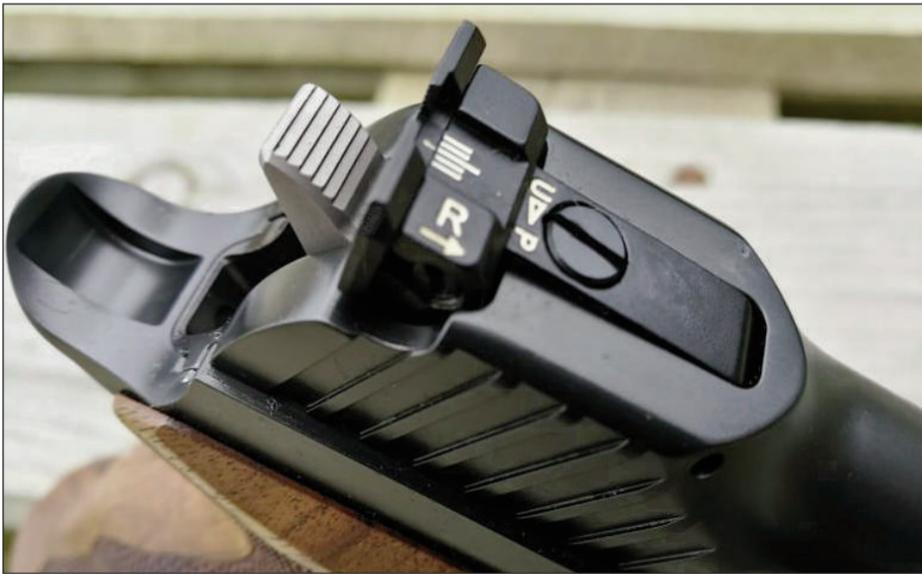
El alza es regulable en altura y deriva con un simple destornillador
