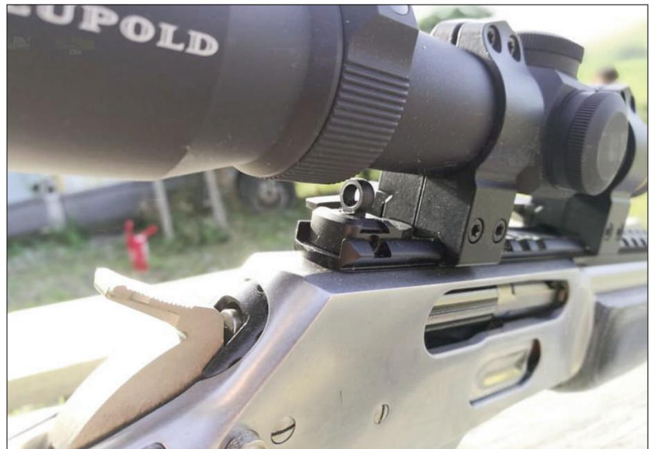
El alza es del tipo "peep" y se puede desmontar para instalar más bajo el visor
