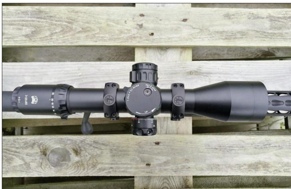
Vista cenital donde se aprecia en la torreta de altura el tornillo de puesta a cero
