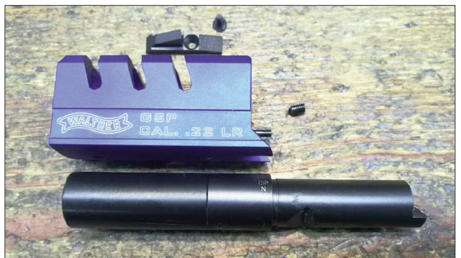
Detalle del cañón y del extremo anterior de la corredera en aluminio azul anodizado
