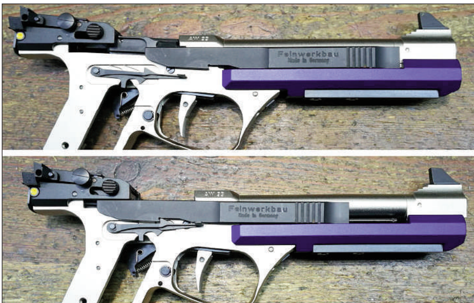
La corredera no retrocede de forma recta, sino que sube una pequeña y casi imperceptible rampa
