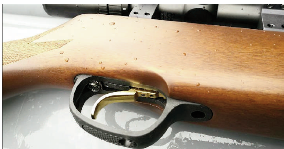
Podemos regular el disparador mediante tres tornillos accesibles desde el exterior
