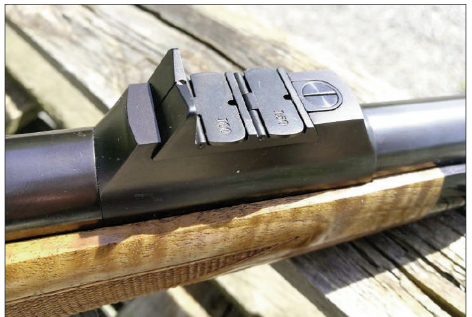
Sistema de alzas de tipo cuchilla con corte triangular graduadas a 50 m, 100 m y 150 m
