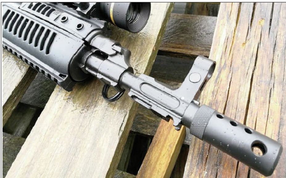
Vista del la bocacha, toma de gases y enganche para la bayoneta
