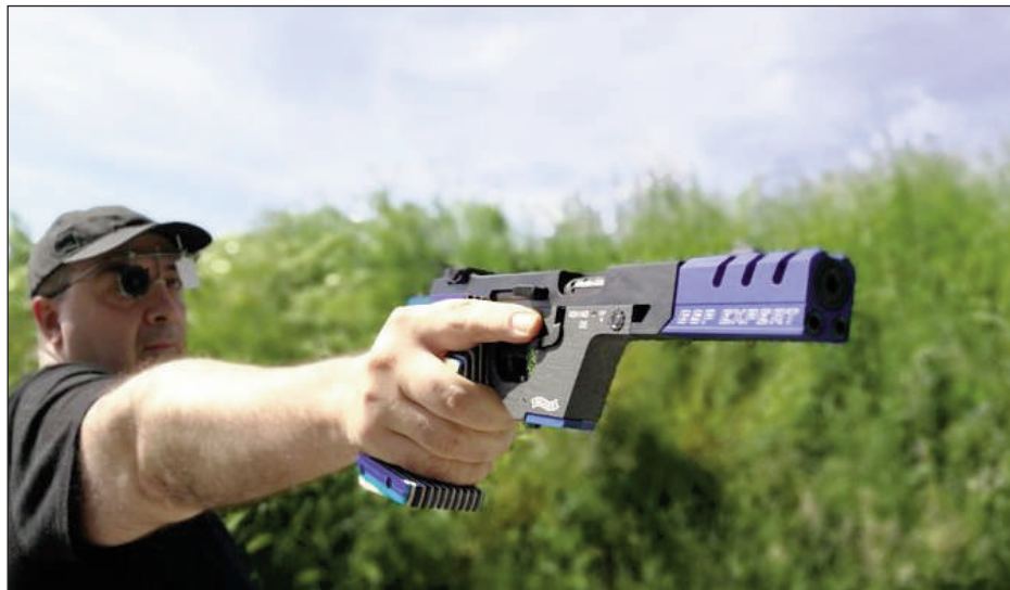
La parte delantera de la corredera es ahora un segmento de aluminio que mejora el equilibrio
