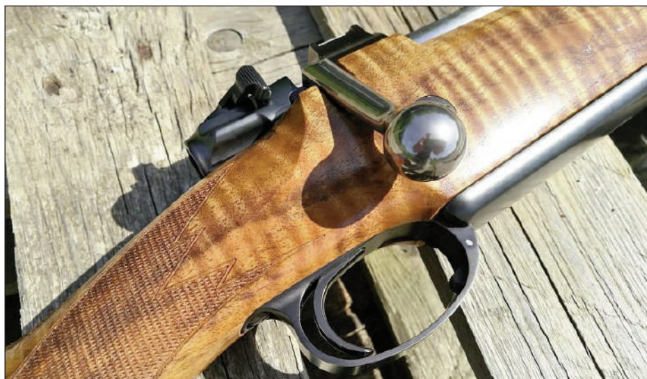
Su disparador es extraordinario: de un solo tiempo, seco, sin arrastres y de recorrido ultracorto
