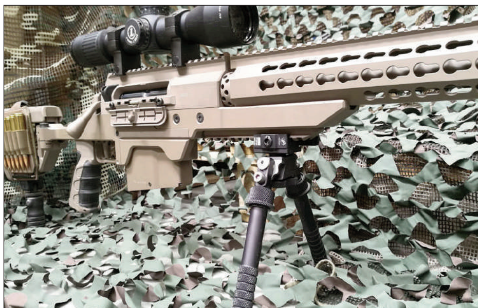
Rail Picatinny sobre el guardamanos y bajo el chasis
