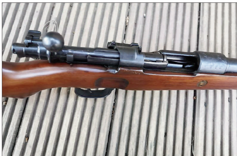
El cerrojo mantiene el control sobre la vaina del cartucho en todo momento
