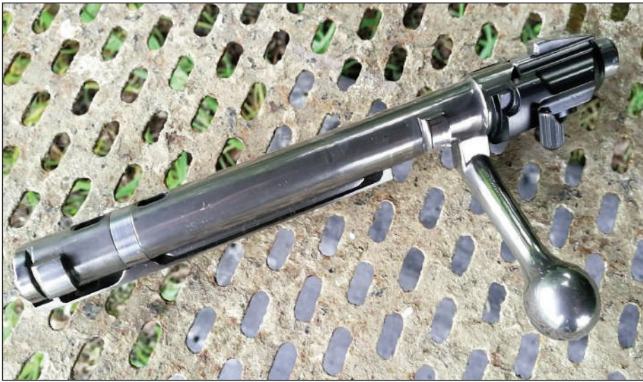
Cerca de la base de la maneta del cerrojo podemos observar el tetón trasero de seguridad
