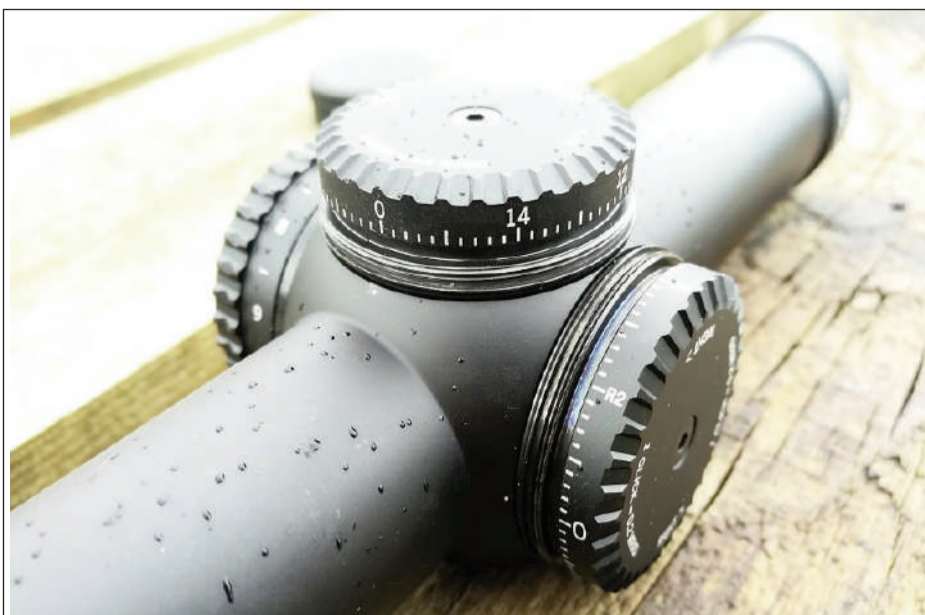
Las ruletas de altura y deriva presentan algo de dureza en el PST Gen II
