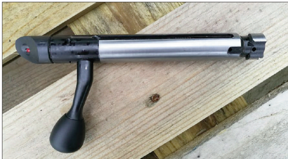
El cerrojo tiene dos eyectores en su cabeza que garantiza la exoulsión de las vainas percutidas
