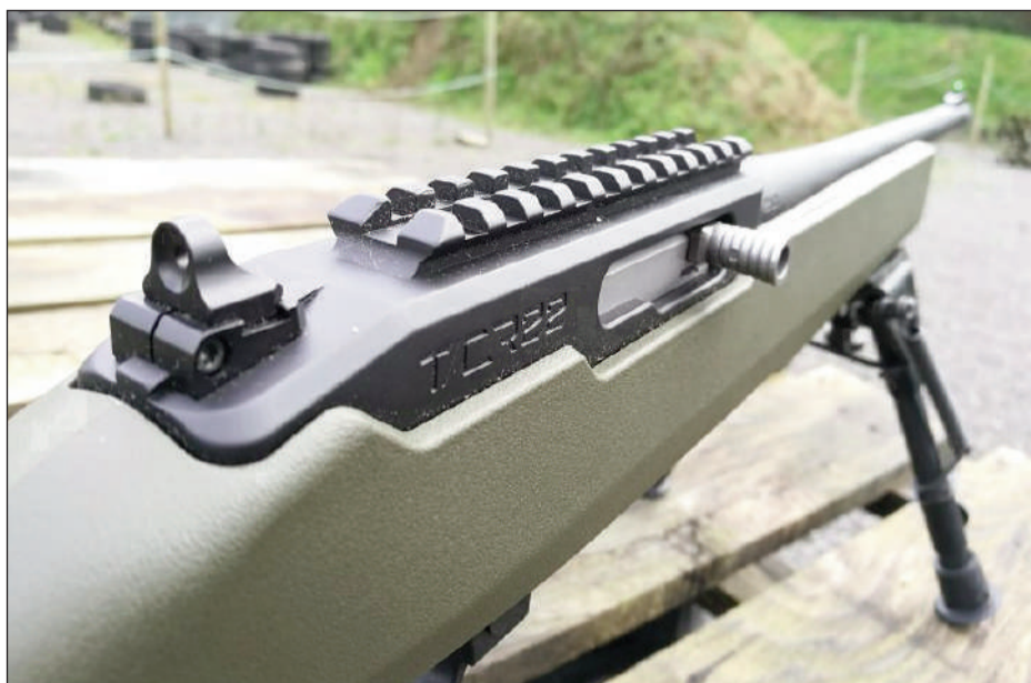
Vista del alza y del rail Picatinny directamente mecanizado sobre la acción
