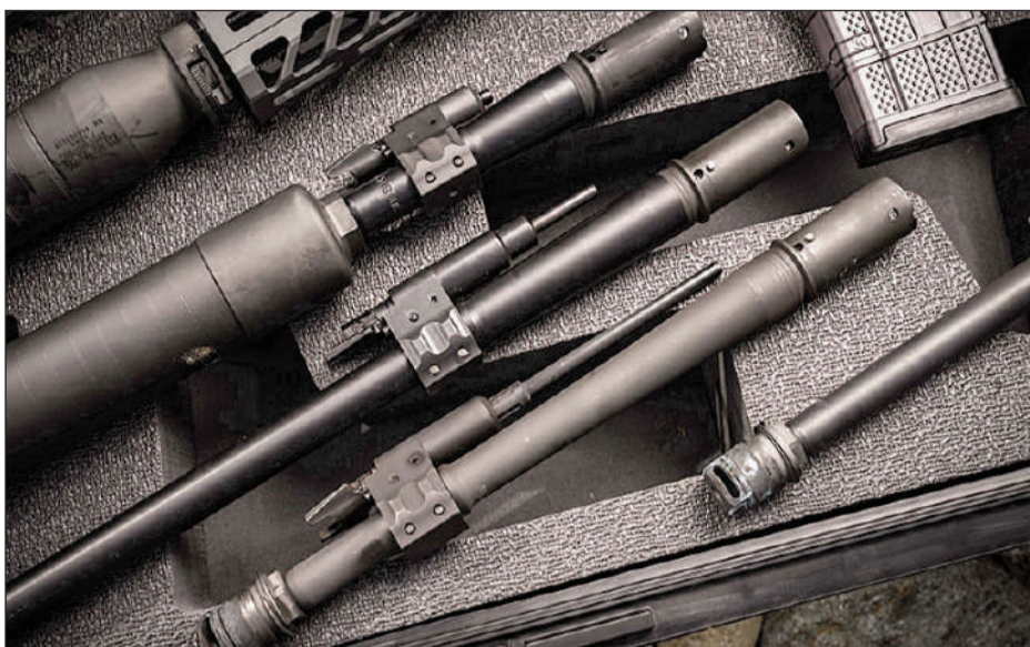
El cambio de cañón tan solo necesita un destornillador Torx T27
