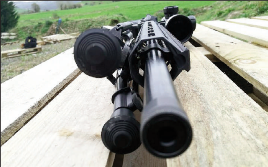
La toma de gases está adelantada, justo al borde del final del guardamanos
