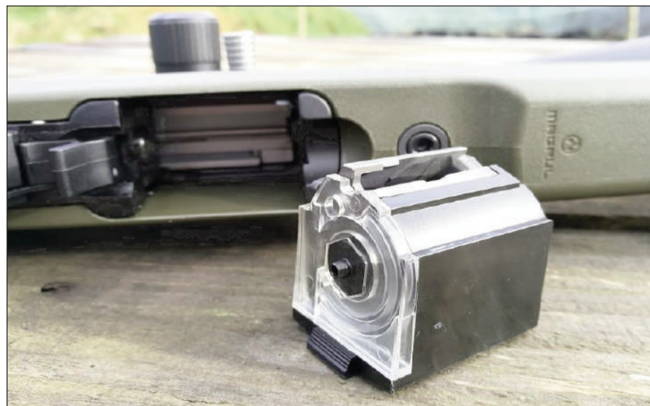
El cargador es de tipo rotatorio con una capacidad estándar de 10 cartuchos
