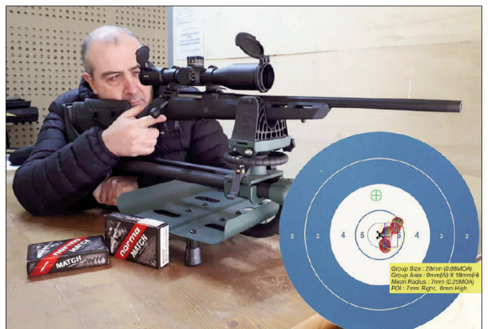
Durante la prueba de precisión obtuvimos una increíble agrupación de 0,68 MOAs a 100 m
