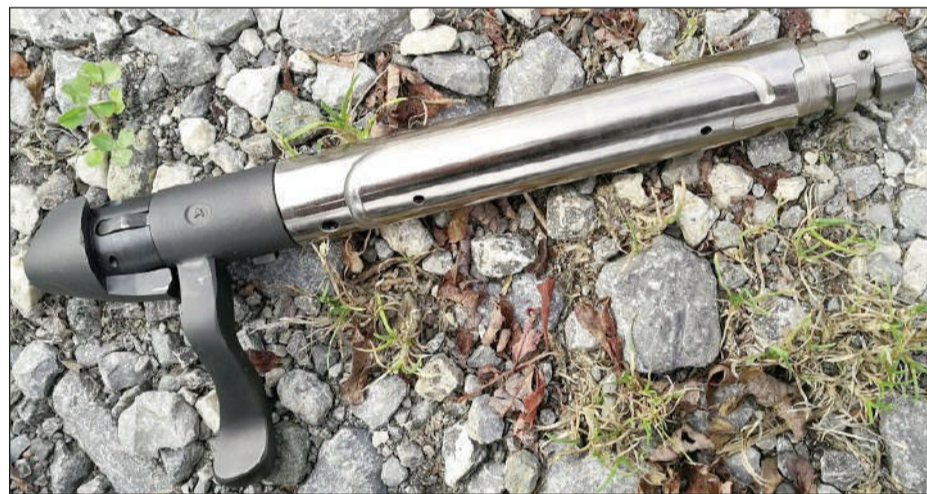
Son visibles los dos pares de tetones y las acanaladuras para garantizar el acerrojado
