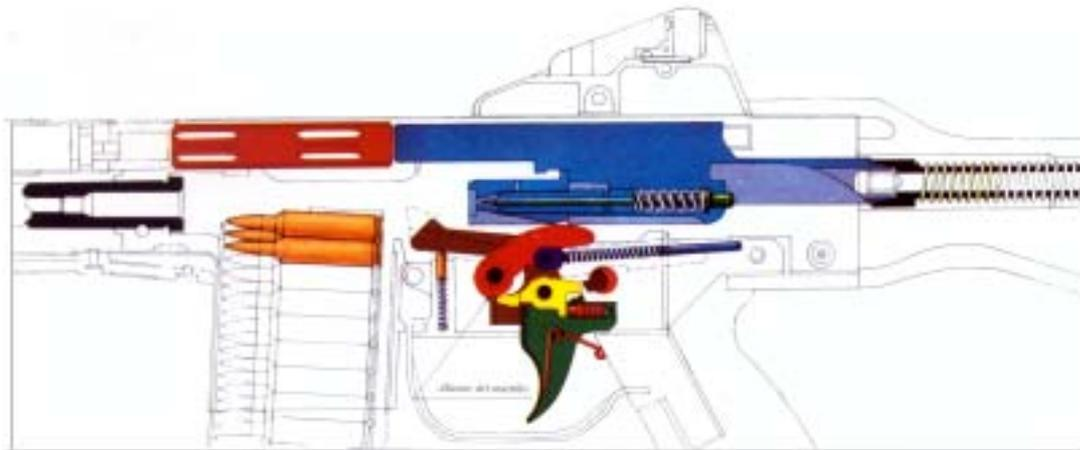
Al haber arrastrado, con la palanca de montar, al cierre hasta su posición más retrasada hemos vencido la resistencia del recuperador-amortiguador, que se encuentra ahora totalmente recogido. Por otro lado, la cabeza del martillo ha ido resbalando por la parte inferior del soporte de cierre hasta queda en su posición más baja. E este movimiento del martillo, el borde de la palanca de seguridad ha ido deslizándose por la cola del martillo hasta quedarse enganchada por su diente.
