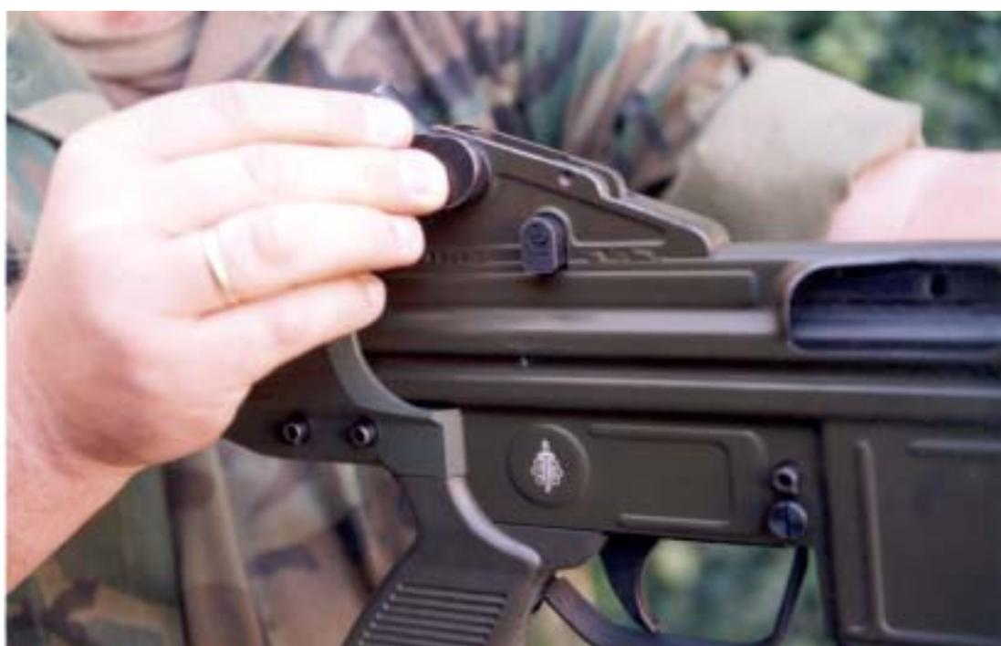
**Fig. 2-17.-Reglaje lateral del alza.**
