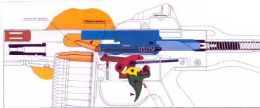
Una vez efectuado el disparo y por la presión de los gases generados en el mismo, el cierre es impulsado hacia atrás. Los movimientos que se producen con los siguientes:
