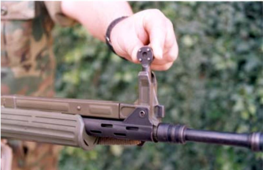
**Fig. 2-18.-Reglaje en altura del punto de mira.**
