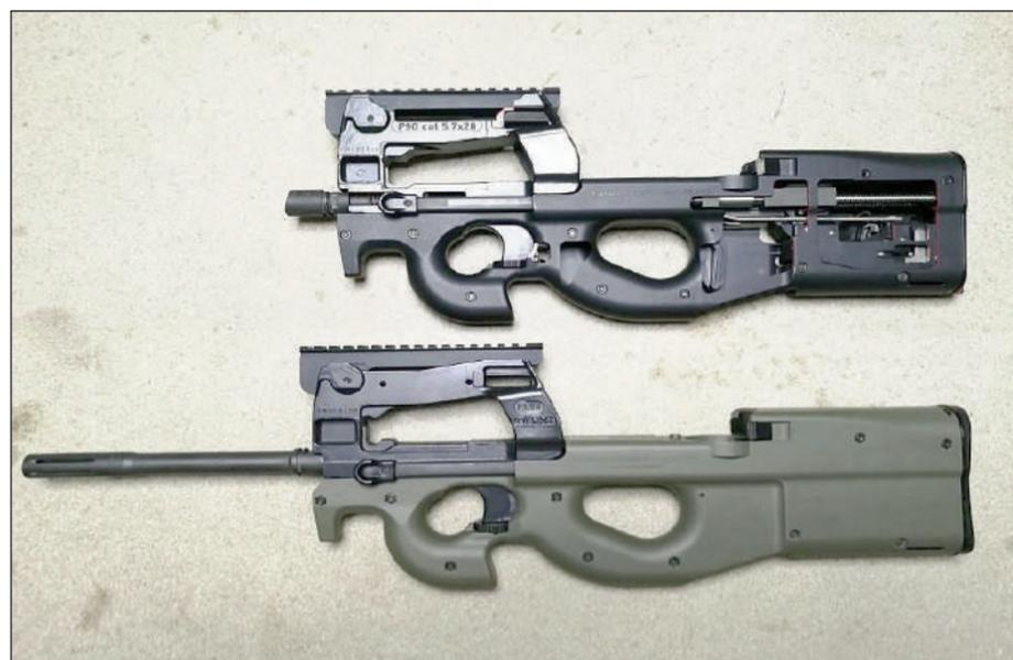
Un FN P90 seccionado para formación con una versión PS90 para uso civil
