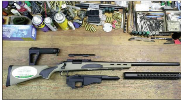
2 - El rifle a transformar es un Remington 700 ADL. Además del kit necesitaremos una culata y un pistolete. Para que se vea la compatibilidad del chasis Remington con la plataforma AR, hemos utilizado una culata más propia de una carabina semiautomática.
