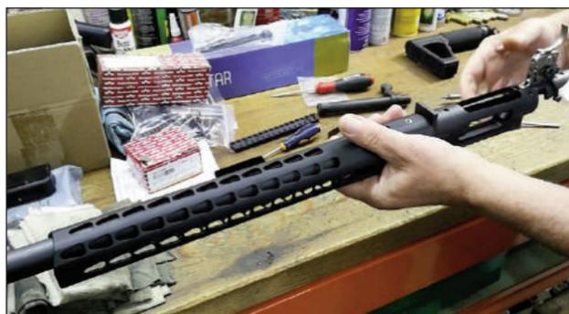
16 – Colocamos de nuevo el rifle en el tornillo de mesa en posición invertida preparándolo para colocar el chasis.
