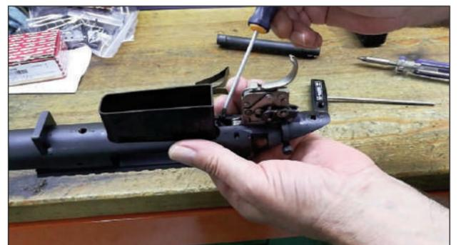
9 - Desatornillamos el depósito de munición, el tornillo está atornillado de forma oblicua.
