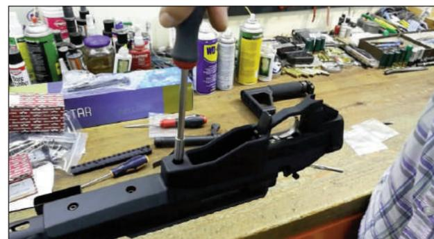
18 – Atornillamos los cuatro tornillos que mantienen unido el chasis a la acción y guardamanos.
