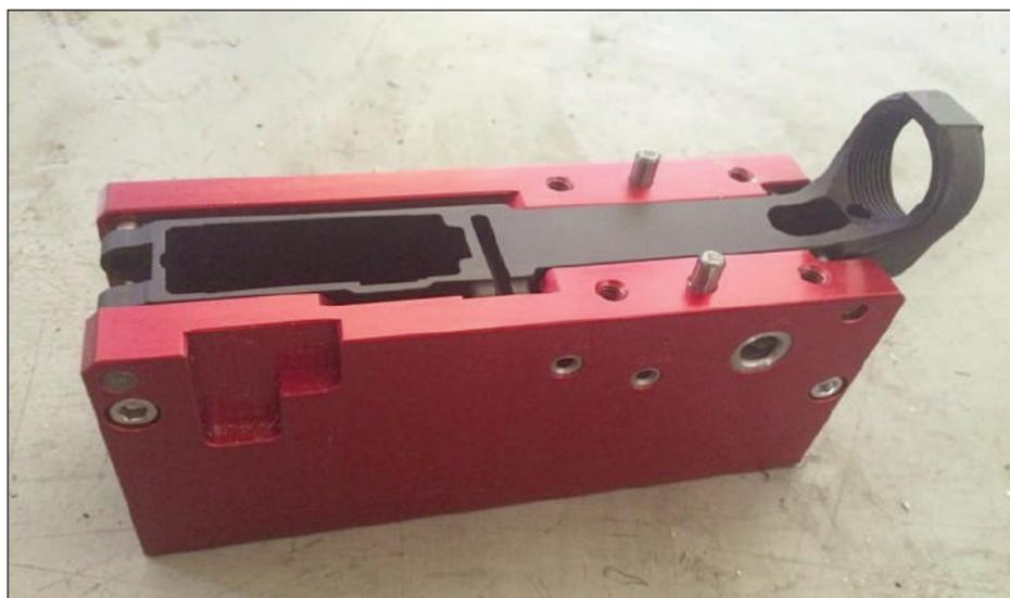
"Lower" o armazón acabado al 80% sujeto con el sistema de plantillas
