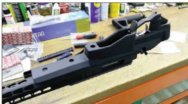
17 – Colocamos el chasis con sus correspondientes tornillos.
