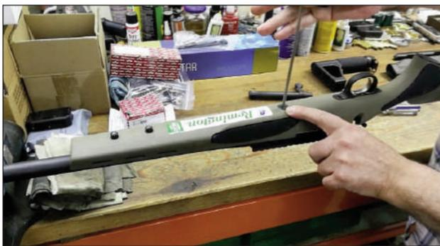
4 - Empezamos a desatornillar los tornillos que mantienen unida la culata a la acción, necesitaremos dos llaves, en este caso la de cuatro..
