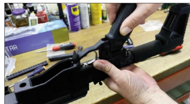
21 – Colocamos el pistolete compatible plataforma AR..
