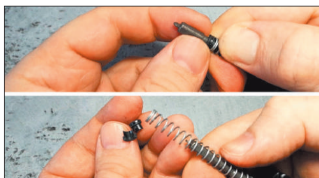
9 - Con una mano replegamos el muelle tanto como sea posible y con la otra desmontamos y sacamos los platillos del muelle del percutor. Es una operación un poco delicada ya que es habitual que los platillos puedan salir impulsados si se nos resbala el muelle. A continuación sacaremos el muelle.
