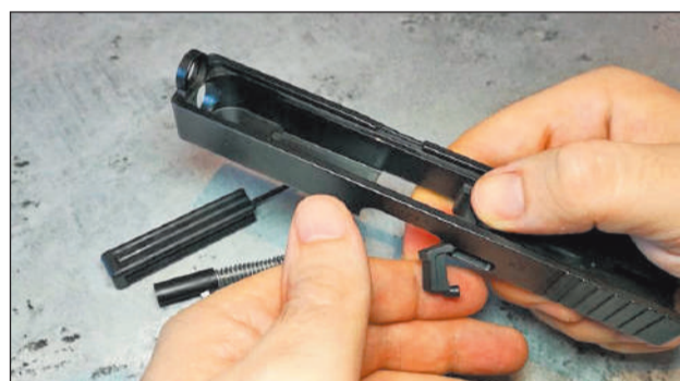
6 - Retiramos la uña extractora mientras presionamos el seguro del percutor. Si la uña estuviere muy sucia podría ser necesario usar un botador para empujarla fuera de su alojamiento.
