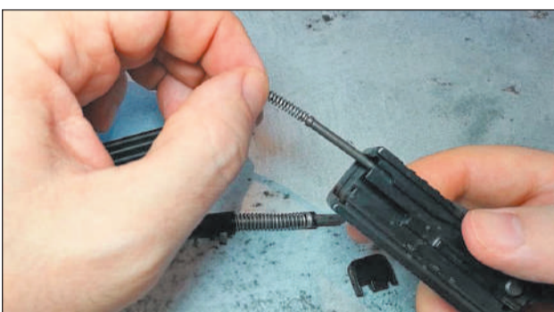
5 - Retiramos el perno de presión de la uña extractora y su muelle, simplemente tirando de él.
