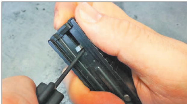
2 - Con un botador presionamos hacia abajo el muelle de la aguja percutora, mientras empezamos a deslizar la tapa de la corredera.
