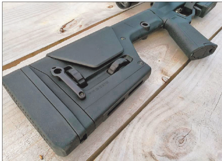
Los principales ajustes de la culata se realizan a través de dos ruedas dentadas de aluminio
