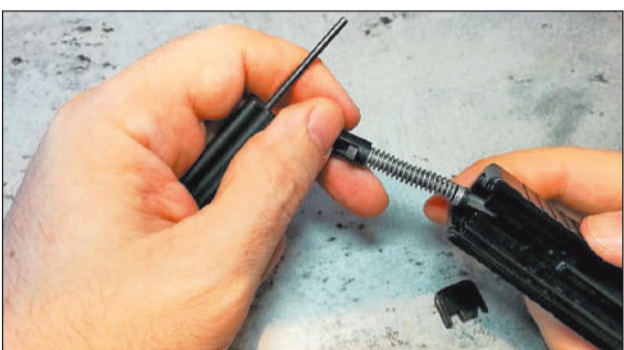
4 - Sacamos la aguja percutora con su muelle de su alojamiento, tirando de su base. Si estuviere muy sucia nos serviríamos del botador para empujarla hacia fuera.
