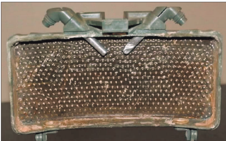
Imagen de los 700 rodamientos incrustados en la resina de soporte
