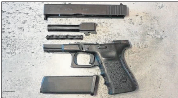
1 - Realizamos un desmontaje básico de la GLOCK 19. Para a continuación desmontar corredera y armazón.
