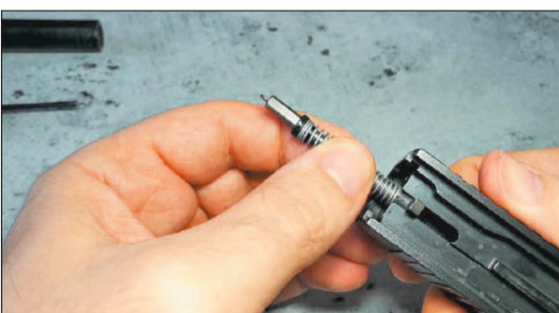
8 - Comenzamos con el desmontaje de la aguja percutora o percutor. Para ello nos servimos de su alojamiento en la corredera y la colocamos de forma invertida para poder trabajar con ella.
