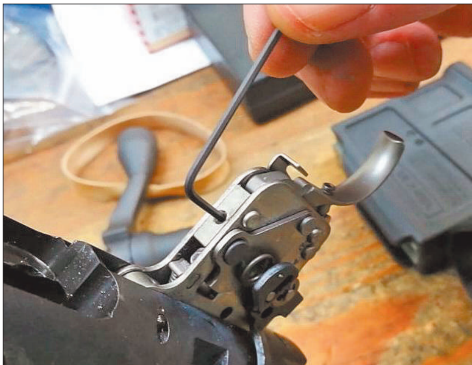
Ajuste del peso del disparador con el tornillo delantero
