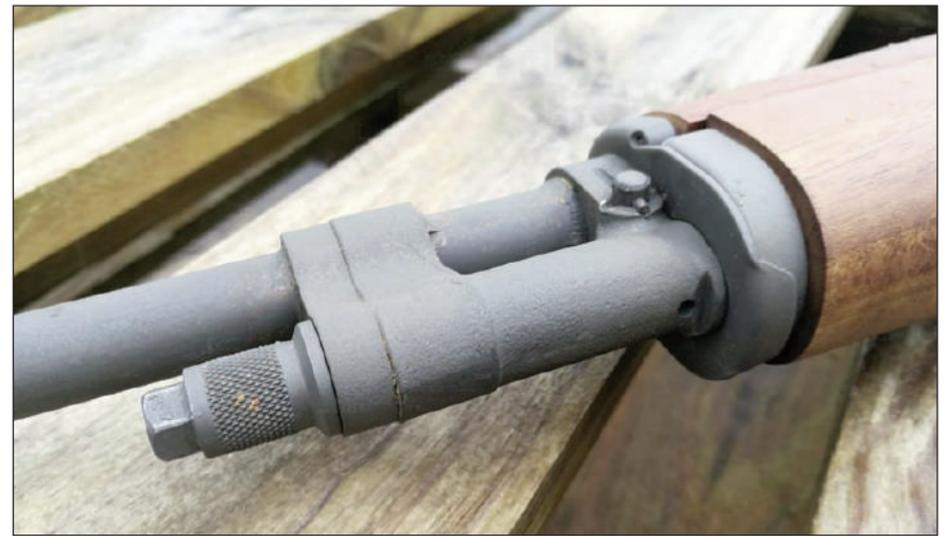
Vista del orificio de evacuación de gases del sistema de pistón
