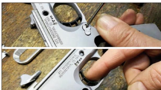
26 – Desatornillamos la retenida del cargador empujando ligeramente desde el lado izquierdo con el dedo. Después, no tenemos más que empujar suavemente el gatillo para sacarlo por el lomo del arma.
