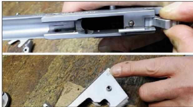
19 – Abatimos el martillo guiándolo con la mano y nos preparamos para sacar el lomo de la empuñadura. Para ellos tenemos que quitar previamente un pasador que lo mantiene asegurado. Colocamos una madera bajo la empuñadura para sacarlo fácilmente.
