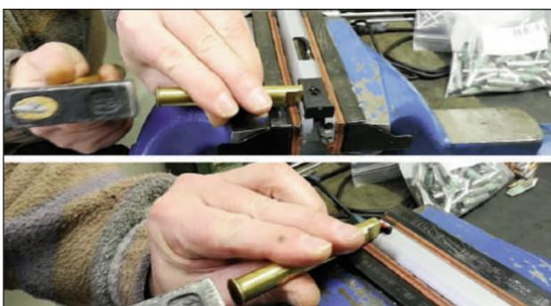
11 - Con un botador de latón empujamos el alza y el punto de mira para sacarlos por el lado derecho. Va a requerir que nos apliquemos porque están firmemente engarzados.
