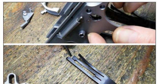
24 – Sacamos el muelle de tres patas que está alojado en el lomo. De izquierda a derecha da tensión a: fiador, gatillo-desconector y al seguro de empuñadura.
