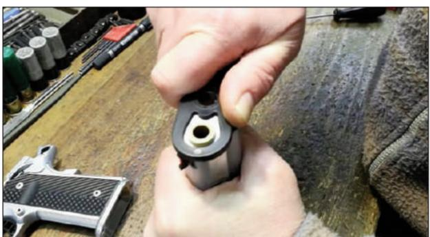
4 - Quitamos el bushing mediante una llave específica de plástico, incluida en el maletín del arma.
