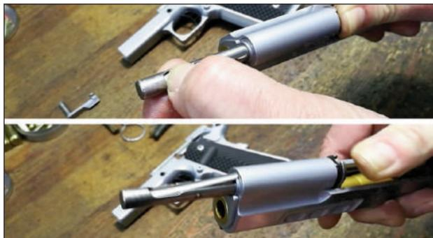
2 - Una vez desmontada la corredera del armazón, empujamos la guía del muelle recuperador. Esta tiene un pestillo que permite mantener el muelle comprimido, mientras realizamos el resto de operaciones.
