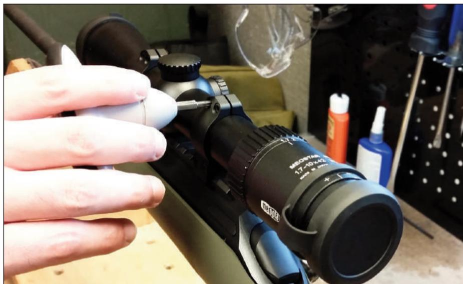
El apriete regular de las anillas con una llave dinamométrica es una de las soluciones
