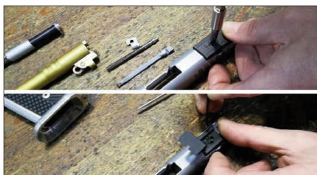
9 - Quitamos el tornillo central del alza con un destornillador de cabeza plana afilada, ya que la ranura es especialmente estrecha. Levantamos la tapa teniendo especial cuidado con los muelles y desenroscamos los tornillos de cabeza allen.
