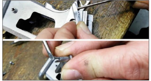
15 - Primero montamos el martillo y procedemos a desmontar el seguro de aleta, comenzamos por el del lado derecho. Nos servimos de un destornillador de cabeza plana fino. Podemos apreciar en la foto, como engancha con la aleta izquierda.
