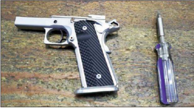
13 – Comenzamos con el desmontaje del armazón, para ello necesitamos un destornillador allen 3/32.
