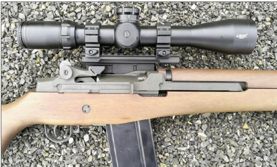
Vista del cajón de mecanismos y el visor Bushnell Elite Tactical Hunter LRHSi de 4,5-18x44 FFP
