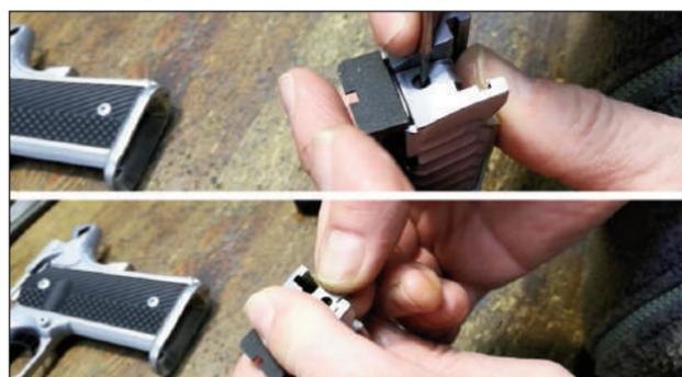
6 - Sacamos la tapa del alojamiento de la aguja percutora. Para ello utilizando un destornillador fino, empujamos la base de la aguja y desplazamos la tapa hacia abajo, tirando de ella con los dedos.
