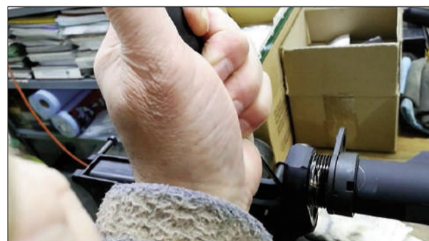
6 – Desenroscamos la culata teniendo cuidado de no perder el bulón que sirve de tope del "buffer" ya que este es empujado por un muelle. Nos servimos de un destornillador para mantenerlo en su sitio.
