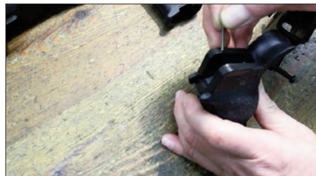
6 - Introducimos el muelle en el orificio donde se aloja en la nueva empuñadura.
