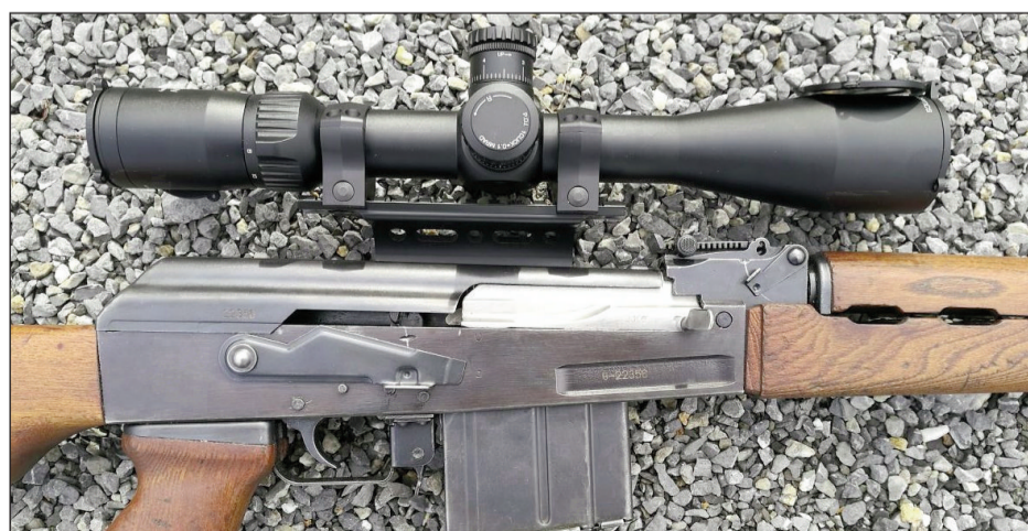
El cajón de mecanismos es un bloque de acero mecanizado
