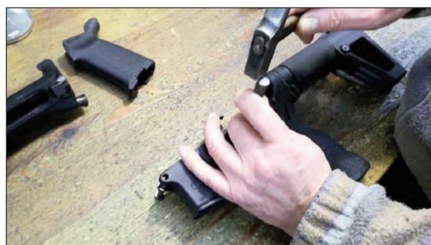
2 – Extraemos los dos pasadores del "lower" que mantienen sujeto el disparador, ayudados por un botador y un pequeño martillo. Empezamos por el pasador anterior.
