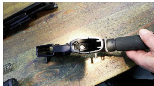
3 – Inspeccionamos el interior de la empuñadura con una linterna, tratando de identificar el tipo de tornillo que la mantiene unida al "lower". Este caso necesitamos de un destornillador de cabeza plana, aunque es más habitual que sea de tipo allen.
