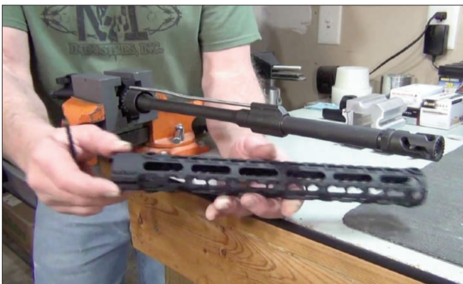
La toma de gases impide vibrar libremente al cañón y su unión varía con el calentamiento
