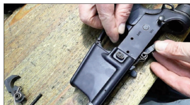
6 – Extraemos el resto de piezas que componen el disparador.
