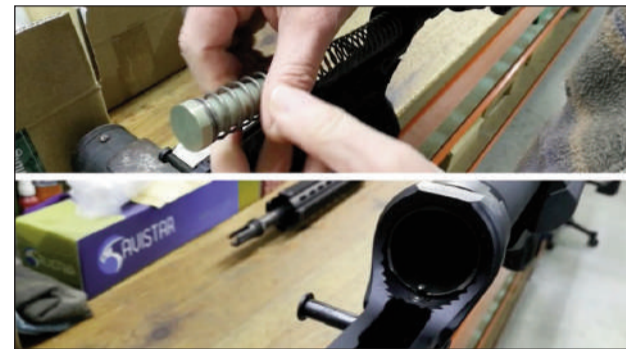
3 – Sacamos el muelle recuperador y "buffer" presionando el bulón que lo mantiene en su sitio.
