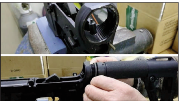
7 – Roscamos la nueva culata en el "lower", teniendo cuidado de colocarla correctamente con respecto al pequeño bulón que mantiene el "buffer" sujeto y la placa metálica que retiene el muelle del pasador trasero del "lower".
