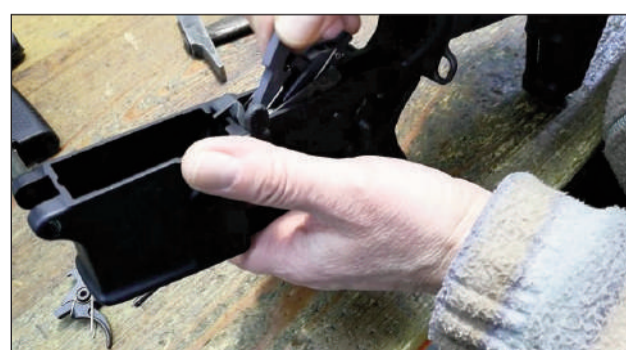
7 – Introducimos el nuevo disparador, que es un casete completo, bastante más fácil de colocar.
