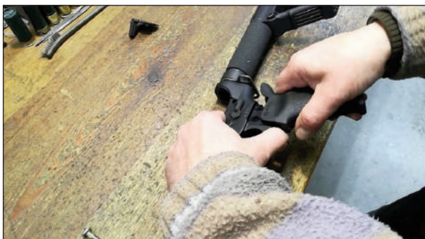
5 - Retiramos con sumo cuidado el pistolete para no perder el muelle que retiene el selector de tiro.
