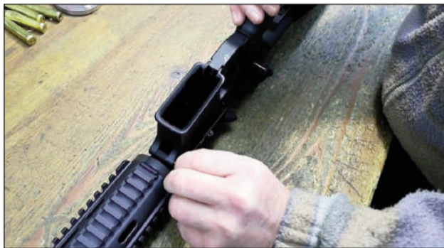
1- Hacemos un desmontaje básico del AR-15, separamos "lower" y "upper" a través de los dos pasadores que los mantienen unidos.
