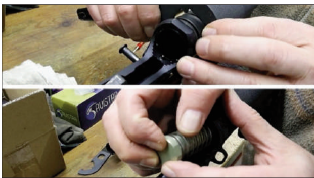
8 – Apretamos la tuerca que asegura la culata al "lower". Introducimos de nuevo el muelle y el "buffer" salvando el bulón que los mantiene en su sitio.
