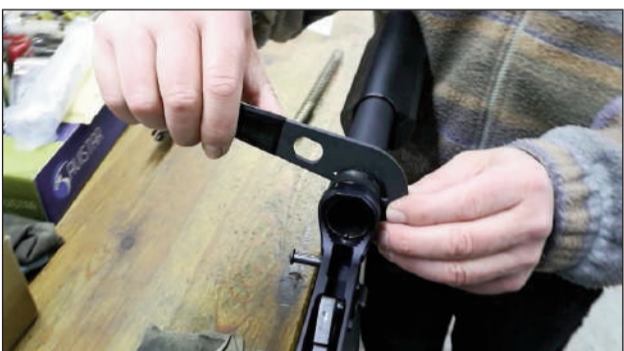
4 – Aflojamos la tuerca que asegura la culata al "lower", para ello utilizamos una llave específica. Puede que esté especialmente dura, ya que algunos fabricantes la suelen asegurar con algún tipo de sellador.
