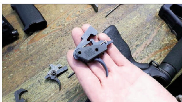
1 – Vista del disparador nuevo a colocar, un Wilson Combat de un solo tiempo.
