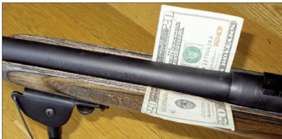
La prueba del billete que permite comprobar como el cañón flota no tocando la culata
