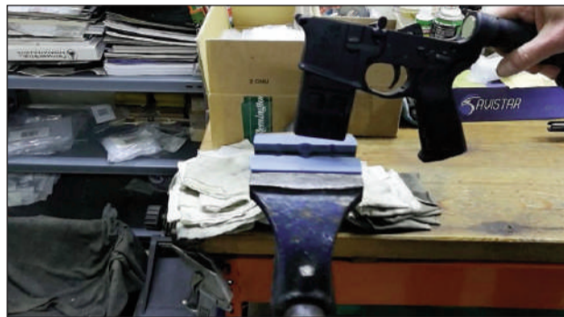
2 – Colocamos el "lower" en un soporte específico para poder trabajar con él en el tornillo de mesa sin que se dañe.
