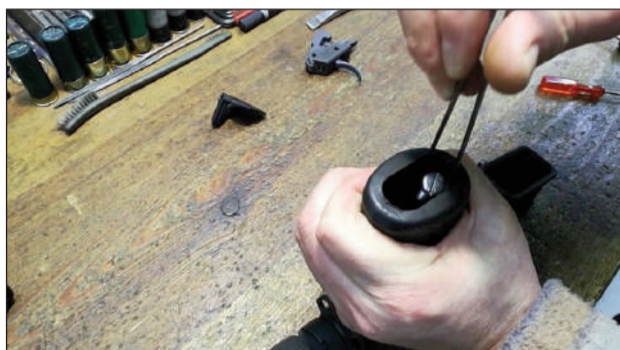
8 – Embocamos el tornillo de sujeción con unas pinzas, algo que no necesitaríamos hacer si se tratase de uno de cabeza allen y atornillamos. Algunos modelos de empuñadura suelen llevar una arandela de seguridad para el tornillo.
