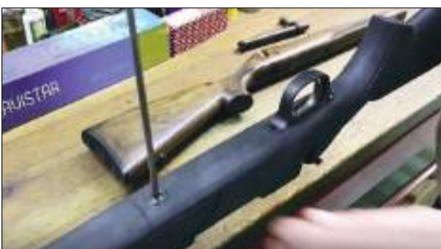
5 – Desatornillamos los tres tornillos de diferente medidas que unen la culata al conjunto cajón de mecanismos - cañón.
