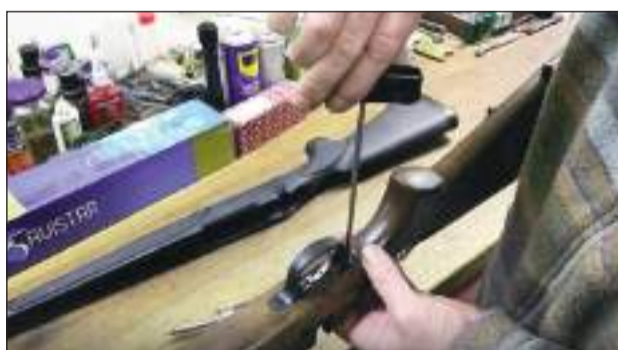
26 – Atornillamos la misma, teniendo especial cuidado con el tornillo más adelantado de los tres, ya que si lo atornillamos en exceso puede llegar a interferir con uno de los tetones de la cabeza de cerrojo. Colocaremos el cerrojo y comprobaremos su correcto funcionamiento.
