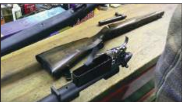
7 – Retiramos la culata de fibra y dejamos a la vista en cajetín del depósito de munición, su muelle y el disparador.
