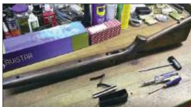
22 – Una vez colocado el nuevo disparador sólo nos queda colocar la nueva culata de madera para nuestro Remington 700 ADL.
