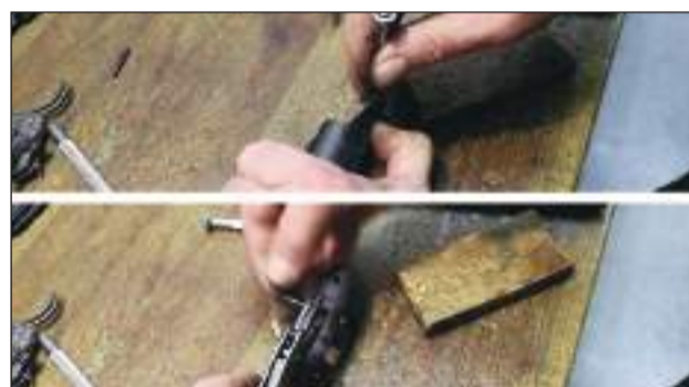
19 – Para asegurarnos que el pasador recoge la retenida y su muelle, alineamos los tres elementos con un pequeño destornillador.
