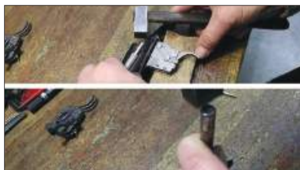
20 – Introducimos el pasador trasero y lo dejamos al ras de la acción, siendo cuidadosos con el botador y martillo.
