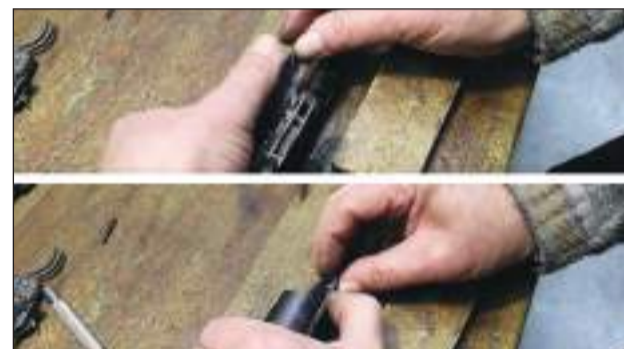
18 – Después colocamos el muelle de dicha retenida, alineándolo con el orificio del pasador trasero.
