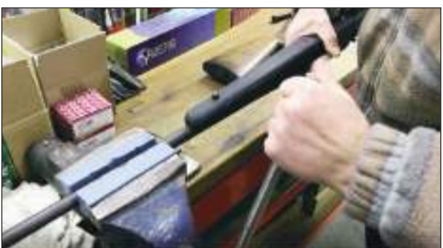
4 – Inmovilizamos el Remington ADL en nuestro tornillo de mesa, mostrando su lado ventral. Previamente habremos retirado el cerrojo.
