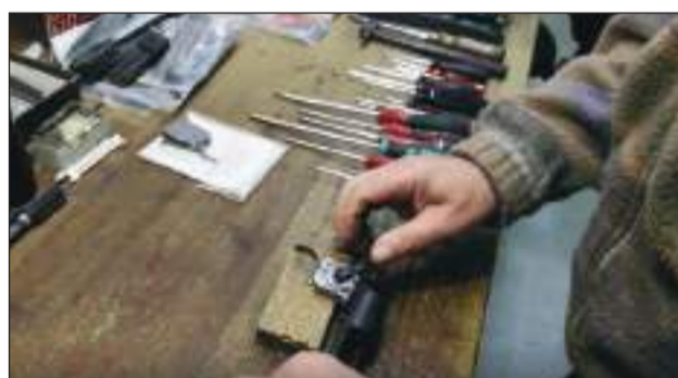
9 – Colocamos el conjunto del disparador sobre un pequeño taco de madera, con objeto de no dañarlo cuando extraigamos los dos pasadores que lo mantienen unido a la acción.
