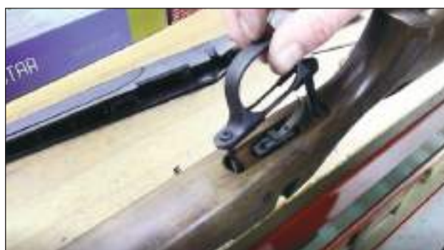
25 – Colocamos el guardamonte cuyos tornillos sirven de sujeción entre la culata y la acción del rifle.
