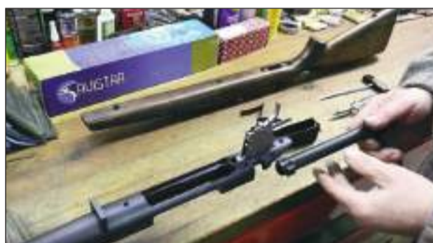
23 – Volteamos el conjunto cañón y acción para poder operar con comodidad y retiramos el cerrojo.
