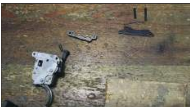
11 - El pasador delantero es más corto que el trasero y al quitarlos quedan sueltos la retenida del cerrojo y su muelle. Además la parte superior del disparador y un pequeño muelle que la empuja quedan sueltos.
