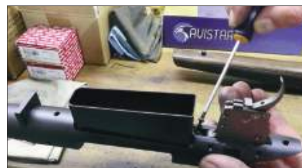
24 – Volvemos a colocar el cajetín del depósito de munición. Debemos tener en cuenta que el tornillo que lo ancla a la acción se atornilla de forma ligeramente oblicua. Si fuese una culata de fibra con tapa de des-alimentación rápida, podríamos aprovechar para colocar un kit de cargador extraíble.
