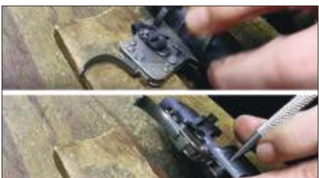
10 – Con cuidado y empleando la fuerza mínima, empleamos un botador y un martillo para empujarlos.
