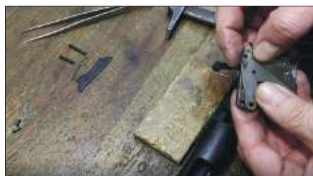
12 – Con objeto de preservar en su posición el kit de disparo original, utilizaremos dos pasadores auxiliares. Para ello introducimos el pequeño muelle en su asiento y presentamos la pieza superior sujetándola con un dedo.
