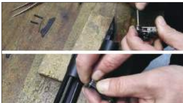
13 – Nos servimos de un pequeño destornillador o un punzón para alinear los orificios e introducimos el pasador auxiliar.
