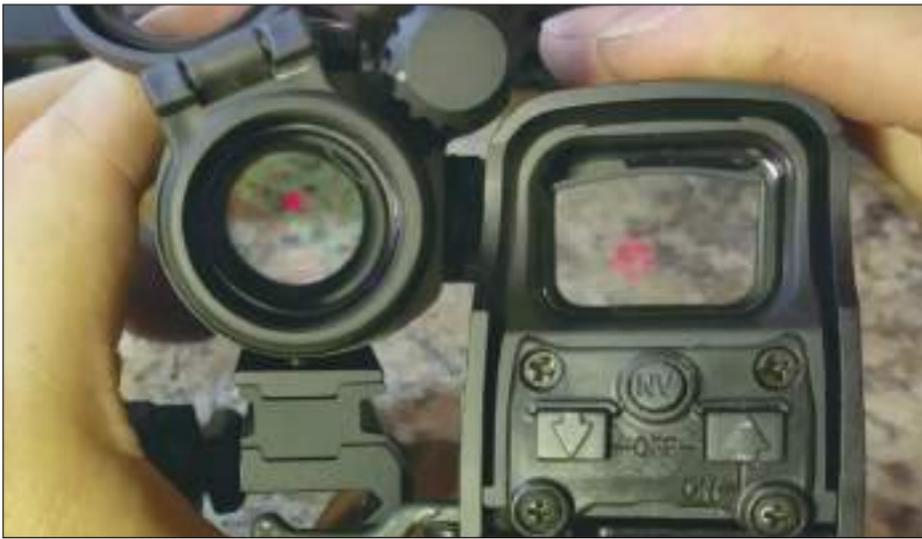
El efecto túnel de los visores de tubo frente a la amplia visión periférica del EOTech
