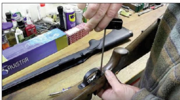
26 – Atornillamos la misma, teniendo especial cuidado con el tornillo más adelantado de los tres, ya que si lo atornillamos en exceso puede llegar a interferir con uno de los tetones de la cabeza de cerrojo. Colocaremos el cerrojo y comprobaremos su correcto funcionamiento.
