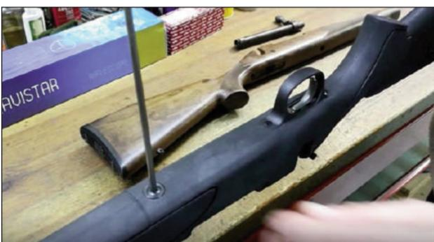
5 - Desatornillamos los tres tornillos de diferente medidas que unen la culata al conjunto cajón de mecanismos - cañón.
