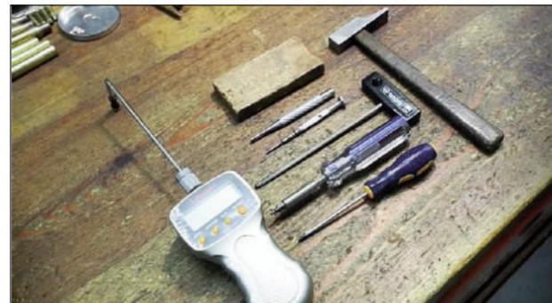
3 - Herramientas empleadas para nuestro taller armero de este número. Llave allen de 4 mm, destornillador punta hexagonal allen 3/32", destornillador punta de estrella, martillo, botador, destornillador fino para alinear orificios, taco de madera para apoyos y medidor Lyman para comprobar peso disparador.
