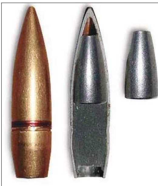
Proyectil seccionado del cartucho 7N1
