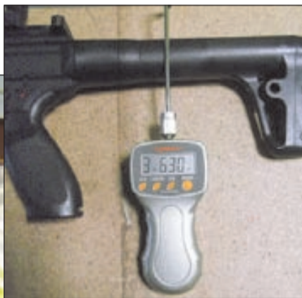
El medidor Lyman arrojó un peso medio de 3,630 kg. para el disparador
