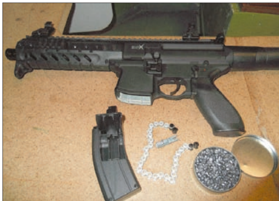
Detalle de la cadena del cargador y herramienta para asentar los balines
