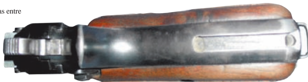
Detalle lomo empuñadura preparado para aceptar culatín
