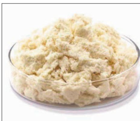
Pulpa de aramida. ¿Quién diría que esto se va a convertir en una fibra altamente resistente?
