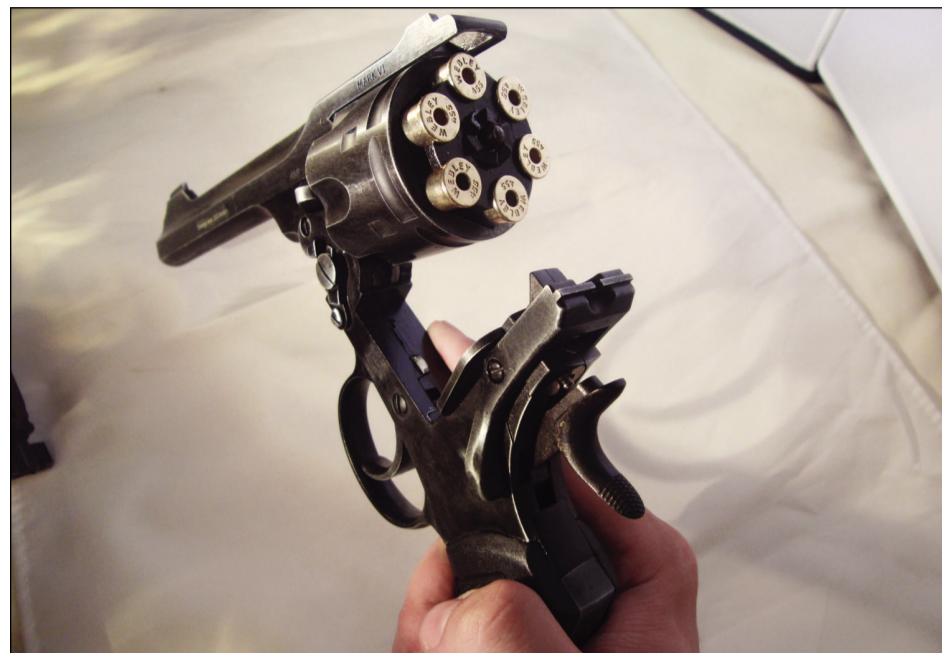
La afamada apertura vertical del Webley Mk VI, en su modelo Battlefield Finish
