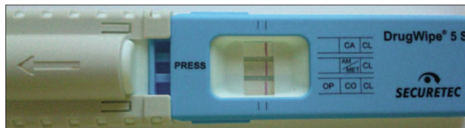
Imagen: Test indicia-rio DRUGWIPE, apreciándose la diferencia entre resultado negativo (izquierda) y positivo a CANNABIS, ANFETAMINAS y COCAINA (derecha)
