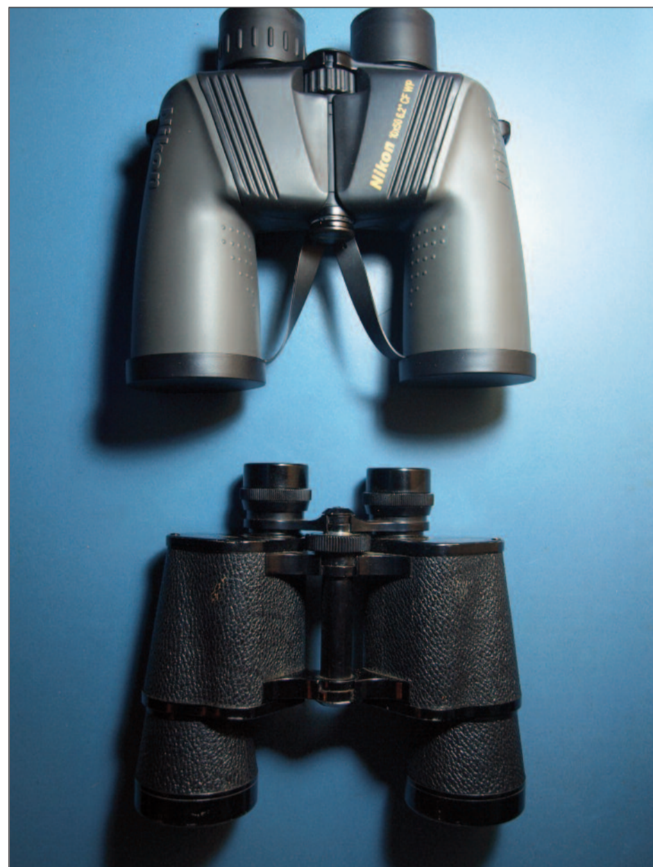
El Nikon 10x50 multicapa comparado con un viejo Zenith 12x50 hard coated
