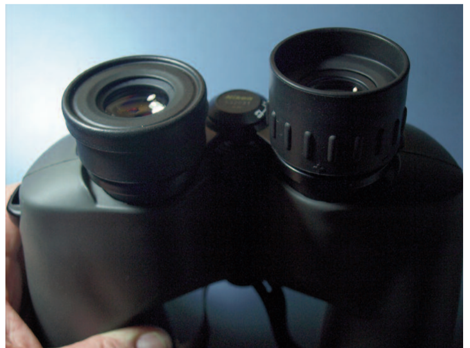
Las copas de los oculares permiten un cómodo uso tanto con gafas como sin ellas y facilitan además la limpieza de unas generosas lentes de 22,5 mm
