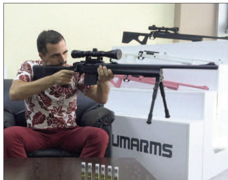
La Quantum Mag 1618, una singular escopeta de cerrojo en calibre 20/76 con cañón "sin obstáculos" para lanzar balas "con efectividad" hasta 250 metros
