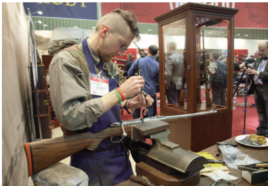
Un "gunmaker" de Rigby trabaja en el ajuste perfecto de unas monturas con resultado final impecable
