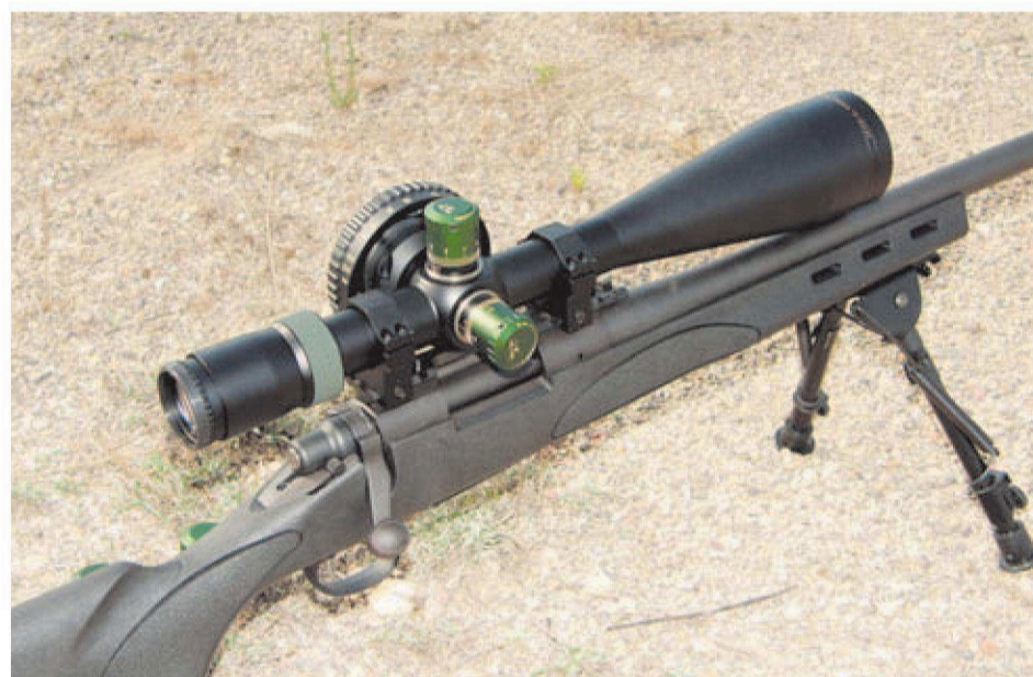
Visor Nikko Stirling Diamond Sportsman 10-50x60 con retícula Mil-Dot, montado sobre un rifle de cerrojo Remington 700. Sus lentes multicapa están fabricadas y tratadas en Japón.
