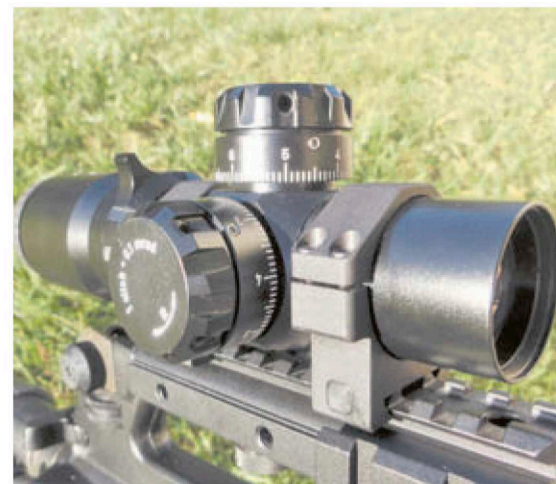
Detalle de las torretas de corrección en altura y deriva. Están sobredimensionadas y su valor es 1 click- 0.1 MRAD.
