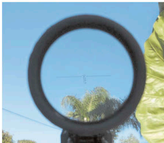
Imagen capturada de la retícula del IOR Pitbull. Como puede verse, el aumento 1x es completamente real.
