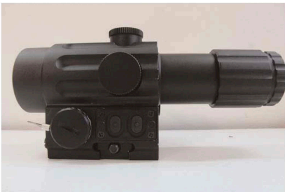
La batería y los botones de ajuste de brillo se encuentran en la parte izquierda del visor.
