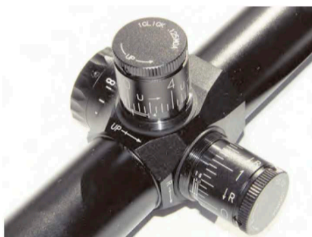
Detalle de las torretas de ajuste del Competition. Corrigen en 1/8 MOA por clic.
