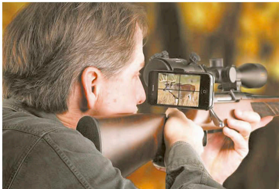
Una de las grandes ventajas del iScope es que permite disparar con los dos ojos abiertos, al mirar a nuestro objetivo a través de la gran pantalla de nuestro teléfono móvil.
