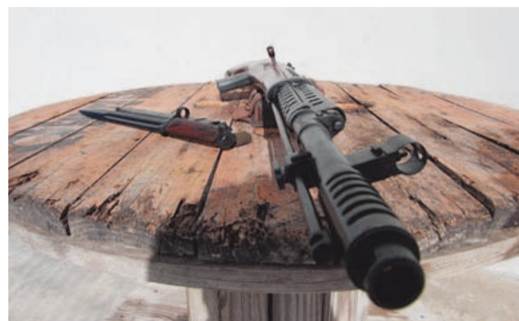
Primer plano del cañón SVT-40. Destaca el apagallamas, un elemento bastante inusual para un arma de tierra en estos años.
