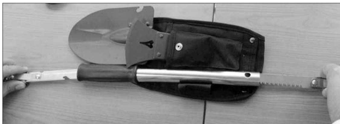
Inteligente sistema de transporte, en el que el mango, lleva en su interior el cuchillo y la sierra.
