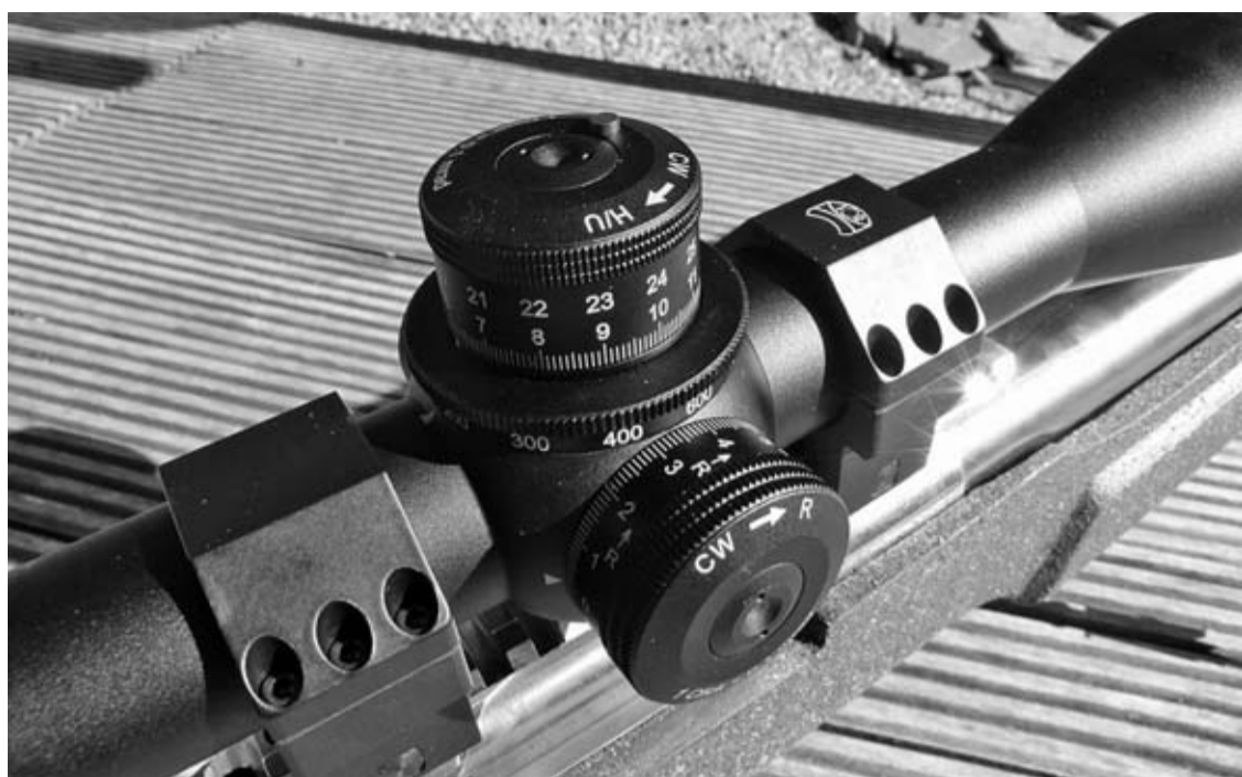
En la imagen destaca la torreta lateral derecha para corrección del viento
