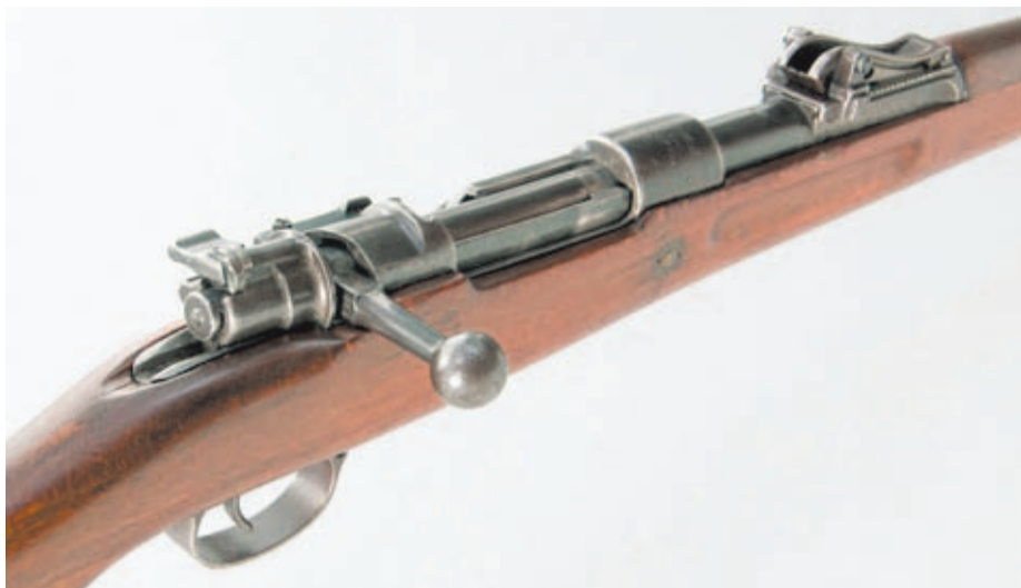
Detalle del cajón de mecanismos de un clásico Mauser 98 en perfecto estado de conservación, con su característica maneta del cerrojo recta y su mira trasera con diseño de rampa.
