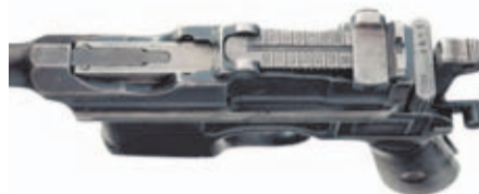
Detalle del alza trasera de la Mauser C96, considerada una de las pistolas más precisas de todos los tiempos. Permitía regular y ajustar el punto de impacto desde 50 hasta 1.000 m.
