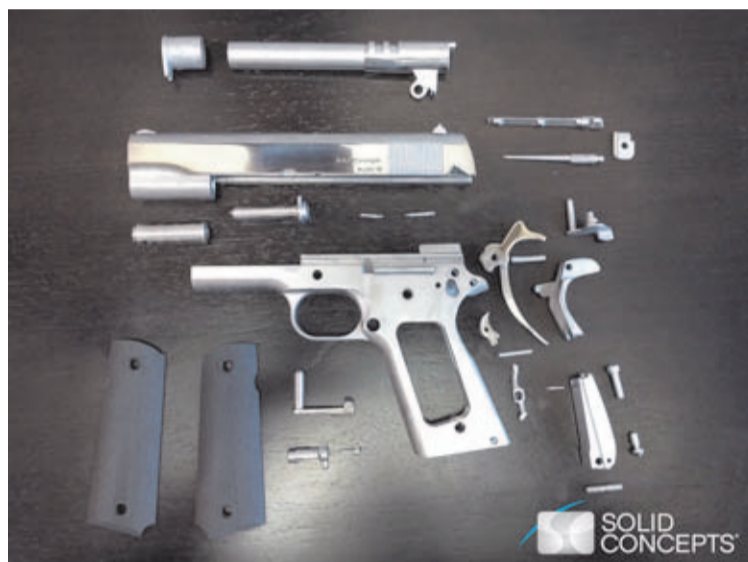
Despiece completo de la primera pistola 1911 con piezas metálicas impresas en 3D por Solid Concepts. En total son 30 piezas de alta resistencia.
