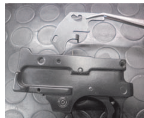
10. Estirar y extraer hacia arriba la leva entera del conjunto del disparador.
