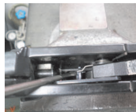
14. Volver a colocar el muelle del disparador en su posición original.
