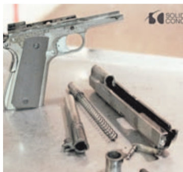
Armazón, corredera, cañón y muelle recuperador de la 1911 impresa.
