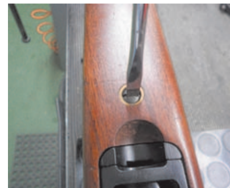
2. Desatornillar y extraer el tornillo inferior que sujeta la acción a la culata.
