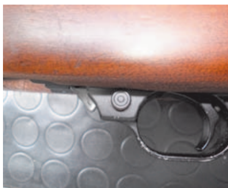
3. Colocar el botón del seguro manual en la posición intermedia.
