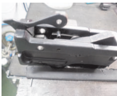
7. Con el pasador ya suelto, extraer esta pequeña leva del grupo del disparador.
