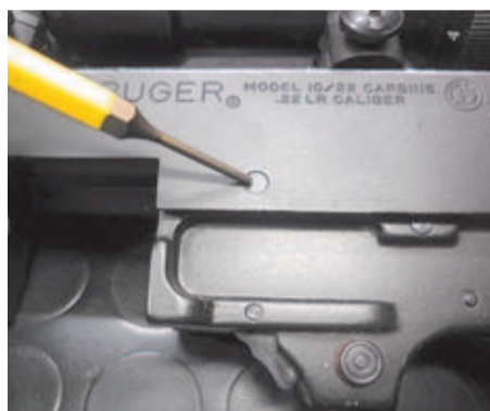
5. Sacar con el mismo botador el pasador delantero del grupo del disparador.
