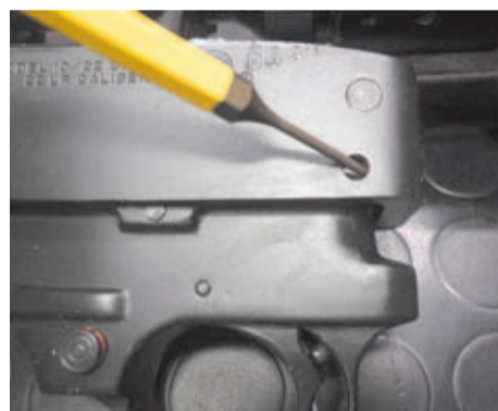
4. Sacar con un botador el pasador trasero del grupo del disparador.
