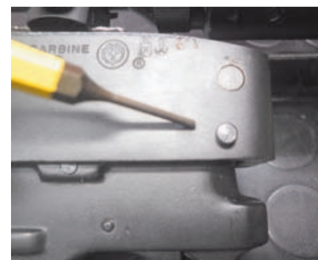
18. Introducir otra vez con el botador el pasador trasero (al revés que el paso 4).
