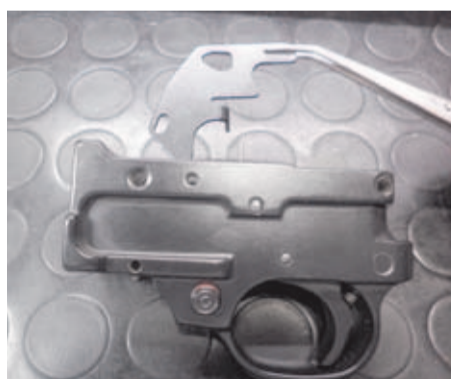
13. Introducir en esta posición la leva limada en el conjunto del disparador.
