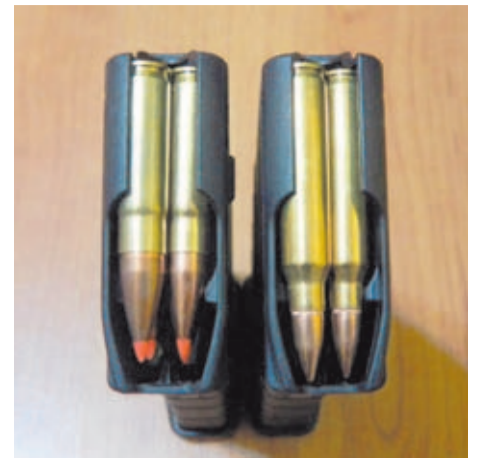
Comparación de 2 cargadores para el Black Rifle. A la izquierda, municionado con cartuchos del calibre .300 AAC BlackOut, y a la derecha con cartuchos del estándar .223 Remington
