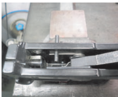
15. Otra vez volver a colocar el pasador bloqueando el muelle, como en el paso 8.
