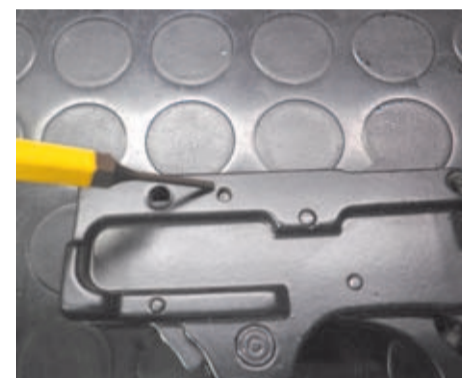
6. Retirar este pequeño pasador superior del grupo del disparador para sacar la leva.
