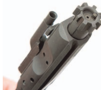
Detalle de la icónica cabeza del cierre del AR15. Esta es una de las piezas más importantes en el fiable rendimiento de este fusil.
