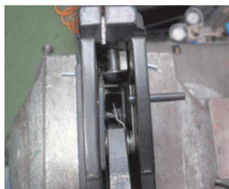
8. Sujetar con el propio pasador retirado, el muelle del conjunto del disparador.
