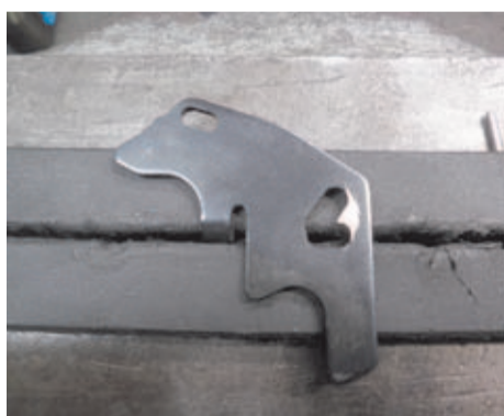
11. Con la leva sobre el torno, marcamos en blanco la parte que tenemos que limar.
