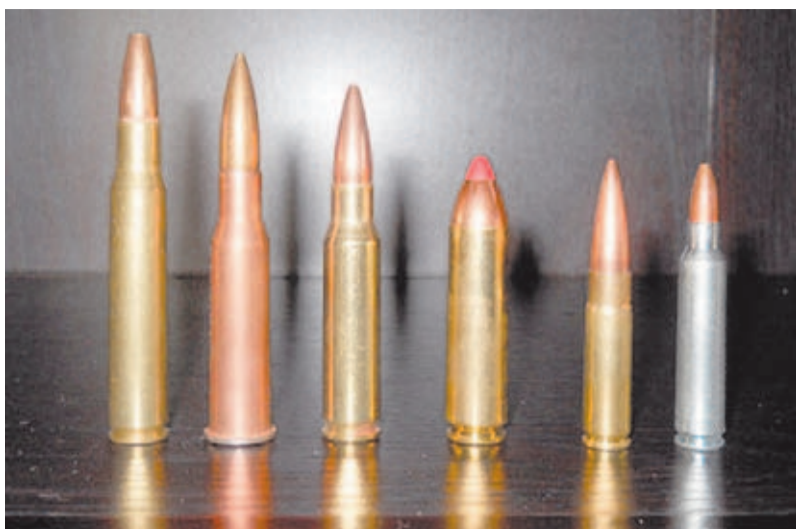
Comparativa de calibres de uso militar y cinegético. De izquierda a derecha: .30-06 Springfield, 7.62x54R, .308 Win, .450 Bushmaster, .300 AAC BlackOut y .223 Rem.
