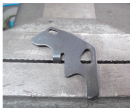
12. Leva completamente limada y dispuesta para volver a colocarse en su lugar habitual.
