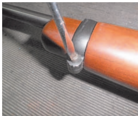
1. Desatornillar y retirar la abrazadera delantera del guardamanos.
