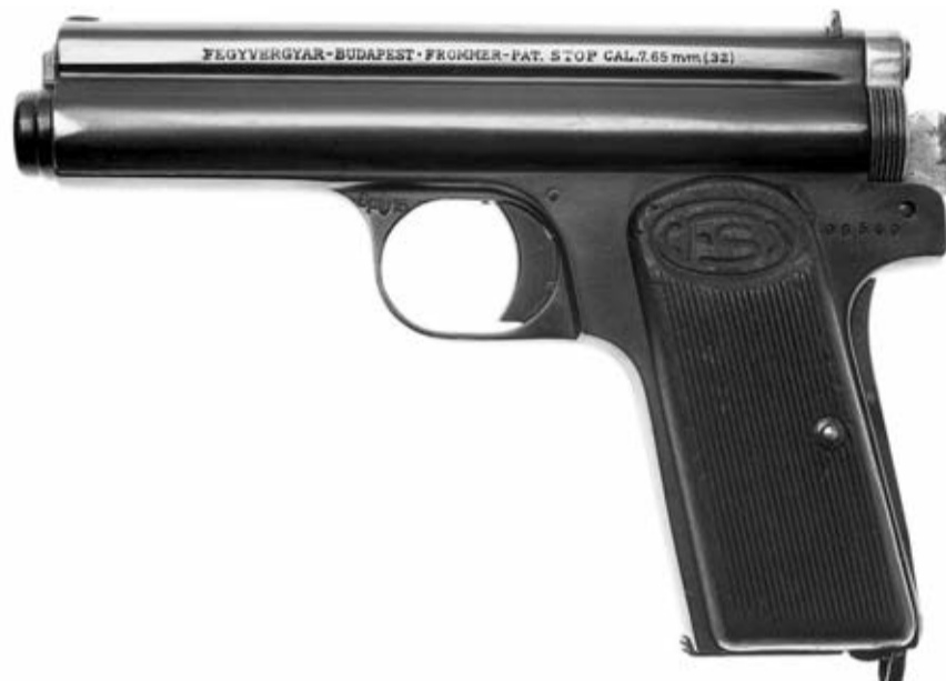
La pistola semiautomática Frommer Stop presenta un original diseño en el que destaca la extraña ubicación de su muelle recuperador: justo por encima del cañón.
