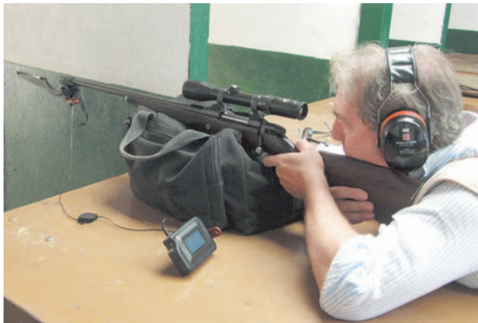
El Magneto Speed es muy sencillo de utilizar y funciona con sólo 3 piezas: el sensor, el módulo de pantalla y el cable de datos. Sobre estas líneas, probando su rendimiento con un rifle 9.36x62.
