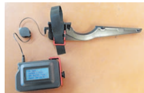
El cronógrafo Magneto Speed se enciende con sólo unir el sensor con el módulo de pantalla.
