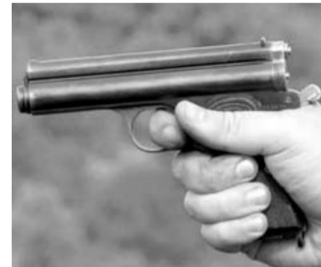
Detalle del martillo a la vista de la Frommer Stop. En la parte superior del armazón se adivinan sus rudimentarios elementos de puntería.
