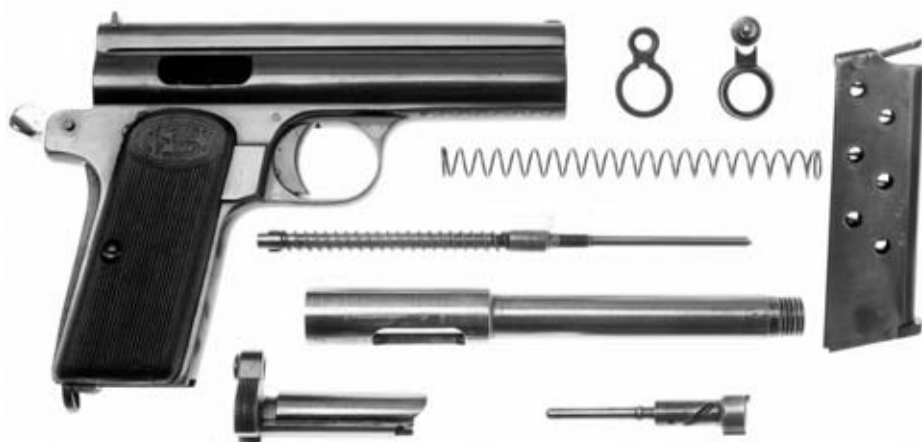
Despiece básico de la pistola Frommer Stop, en el que se observa su largo cañón de 10 cm.
