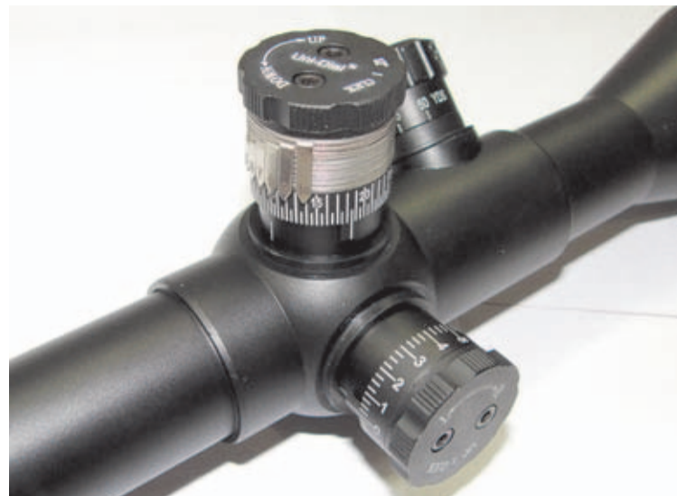
Torretas balísticas del visor Leatherwood Uni-Dial 7-30x50 utilizado por Toby Bridges. La torreta de altura permite memorizar varios puntos de impacto.
