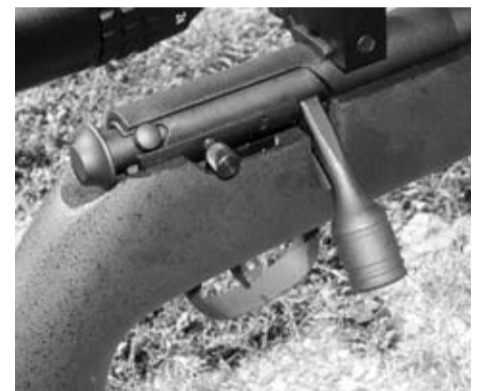
Detalle de la sobredimensionada maneta del cerrojo y de la palanca de su seguro manual.
