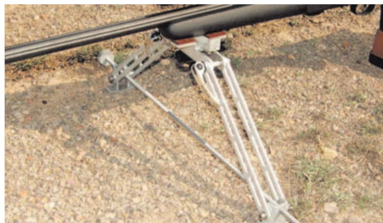
El bípode se instala sobre la anilla del guardamanos habilitada para la correa portafusil en apenas unos segundos.
