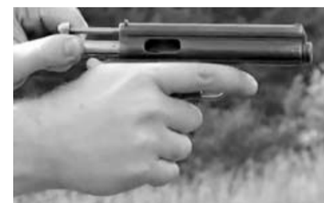
Para alimentar por primera vez la Frommer Stop hay que estirar del cerrojo e introducir el primer cartucho en la recámara.
