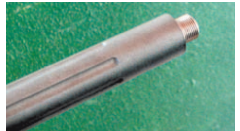
En la imagen superior, un momento de la prueba de tiro a 100 metros. Abajo, detalle del cerrojo extraído de la recámara (izqda.), y del extremo del cañón con su particular acabado roscado.
