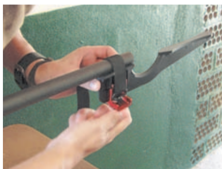
El sensor magnético se coloca justo en la boca de fuego del cañón y se ajusta manualmente.
