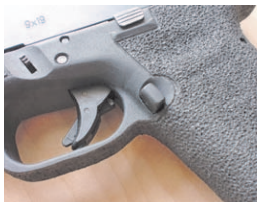
El sistema de disparo "Safe Action" patentado por Glock es realmente una D.A.O. pre-armada.
