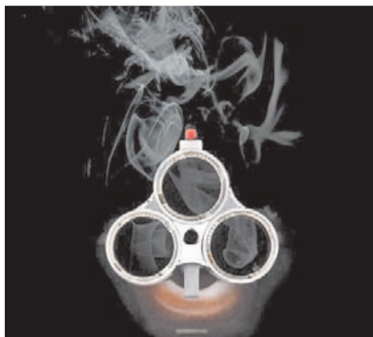
Detalle de la boca de fuego y de la báscula de la "Triple Corona", con los dos cañones paralelos y uno superpuesto.
