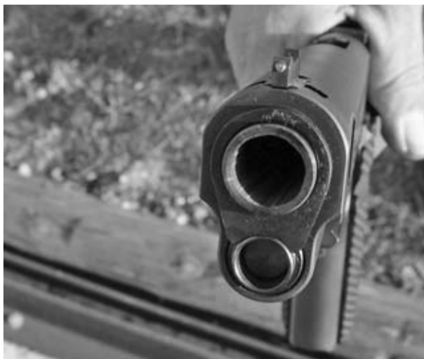
Detalle de la imponente boca de fuego de esta pistola, en la que se deja entrever el estriado interior de su cañón de 5".
