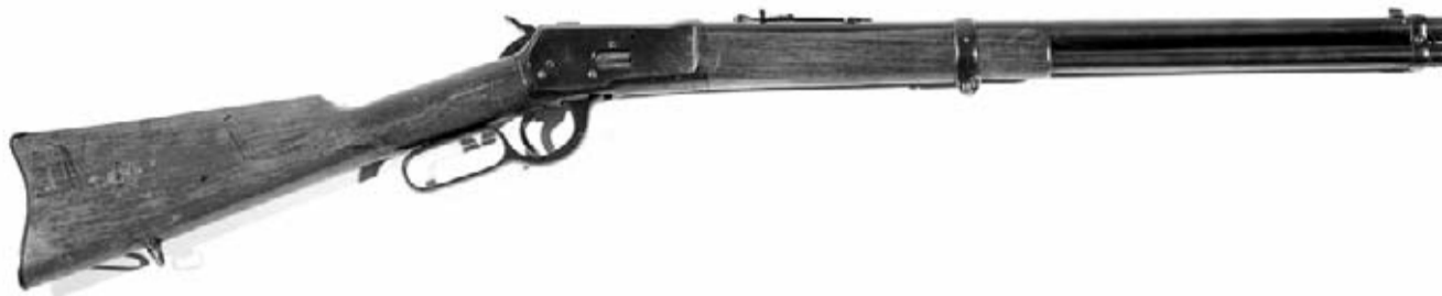
Este rifle TIGRE .44-40 es una excelente adaptación española de la carabina Winchester Mod. 1892. Estuvo en dotación en la Guardia Civil a partir del año 1928, principalmente entre aquellas unidades y grupos encargados de la vigilancia del transporte ferroviario.
