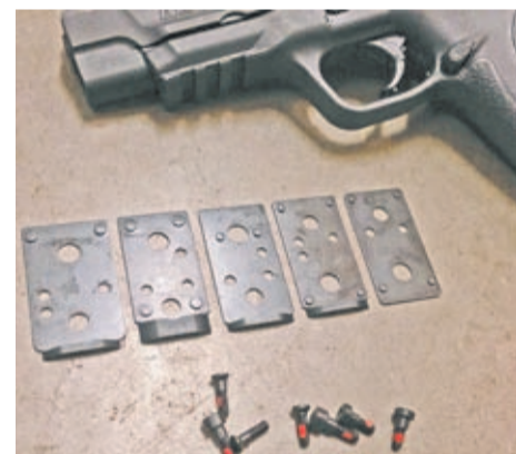
Estas pletinas y tornillos se sirven de serie con la pistola y sirven para colocar los visores.
