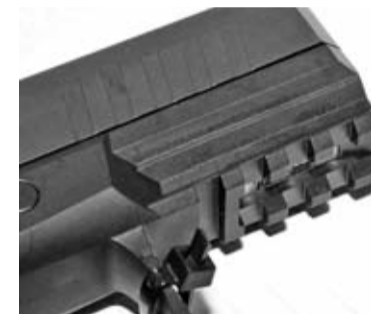
A la izquierda, parte trasera de la corredera, con su alza de 2 puntos y el martillo oculto. A su lado, detalle del raíl Picatinny MIL-STD-1913.
