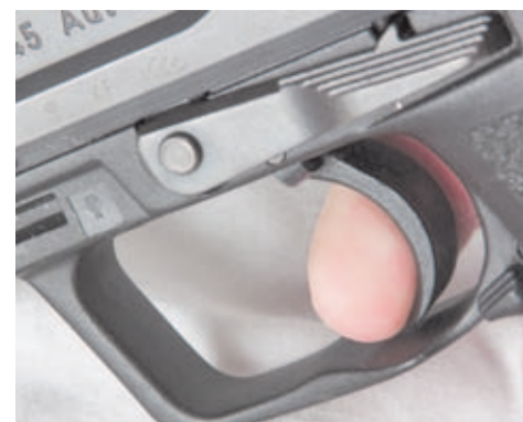
Algunos modelos como esta HK .45 tienen el arco del guardamonte sobredimensionado para poder accionar el disparador con guantes.
