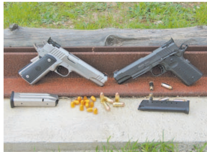
Dos modelos de PARA-ORDNANCE: a la izquierda una versión en calibre 9mm Parabellum con el clásico cargador de alta capacidad de doble hileras. A su derecha, la nueva Black Ops con su cargador de 8 cartuchos.
