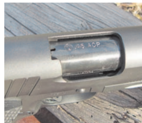
Recámara con el marcaje del calibre .45 ACP.
