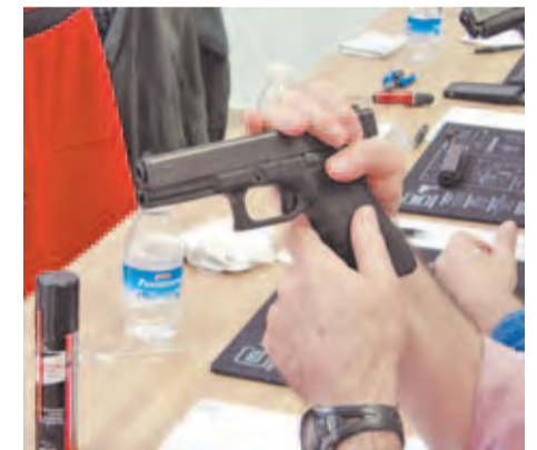
Para liberar la corredera, hay que coger la Glock con los cuatro dedos de una sola mano.
