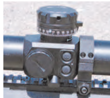
Detalle del cuerpo central del IOR, con los botones para iluminar la retícula.
