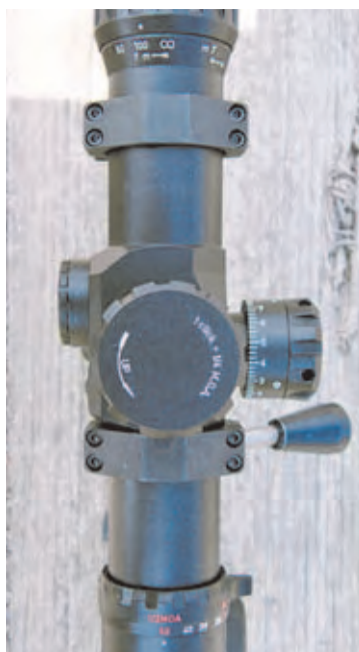
IOR Valdada Terminator visto desde arriba. La torreta de ajuste en altura es realmente grande.
