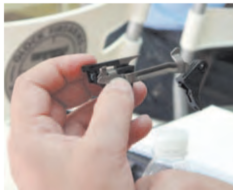
Conjunto del disparador recién liberado del armazón. He aquí el corazón de Glock.
