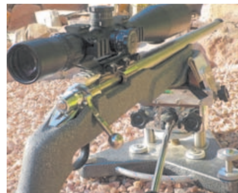
La culata fue la parte que más se modificó. Por un lado, se le incorporó un cuña adicional para que encajara mejor en la torreta, se rebajó su perfil inferior trasero, y se le añadió 1 kilo de plomo.
