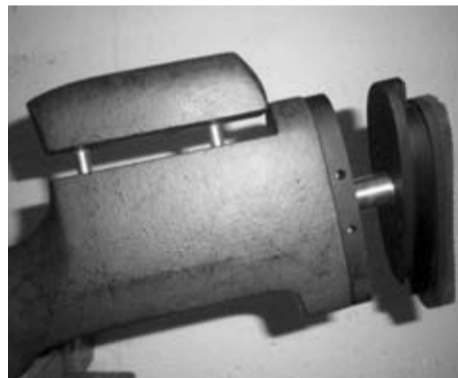
La culata Bell & Carlson que trae este nuevo modelo puede ajustarse en varias posiciones (izquierda). Mientras que su acción Atlas es una evolución de la clásica acción del Remington 700.
