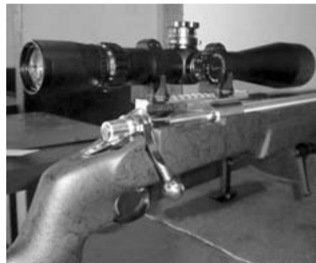
La culata Bell & Carlson que trae este nuevo modelo puede ajustarse en varias posiciones (izquierda). Mientras que su acción Atlas es una evolución de la clásica acción del Remington 700.
