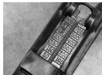
Sistema de miras tipo guión de la C-96.
