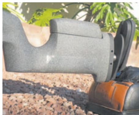
La culata fue la parte que más se modificó. Por un lado, se le incorporó un cuña adicional para que encajara mejor en la torreta, se rebajó su perfil inferior trasero, y se le añadió 1 kilo de plomo.
