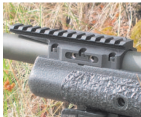
A la izquierda, detalle del "corazón" de PERSEUS. Todos los ajustes y acabados de este fusil encajan a la perfección. A la derecha, riel Picatinny adicional montado al final del guardamanos.
