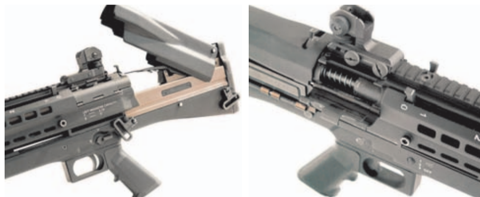
Como puede observarse en la imagen de la izquierda, la UTS-15 se alimenta a través de la culata. Se alza la tapa y se introducen los cartuchos. A la derecha, detalle de la ventana de expulsión.
