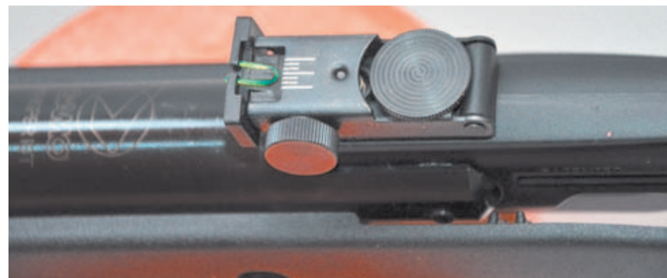
El sistema de miras de la IGT Whisper es muy intuitivo, ya que sus puntos son de fibra óptica.
