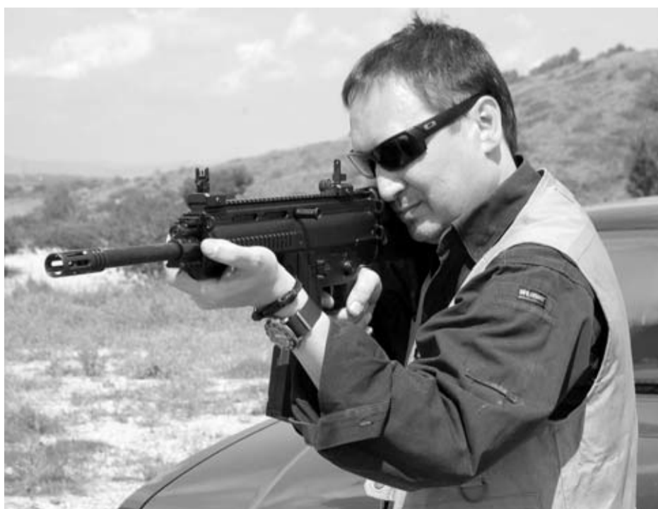
Las miras pueden colocarse a gusto del tirador a lo largo de su amplísimo carril Picatinny.
