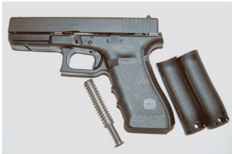
En esta imagen se ven los principales cambios de la 4ª Generación de Glock: los lomos intercambiables, el doble muelle recuperador, el nuevo picado y el botón del cargador agrandado.
