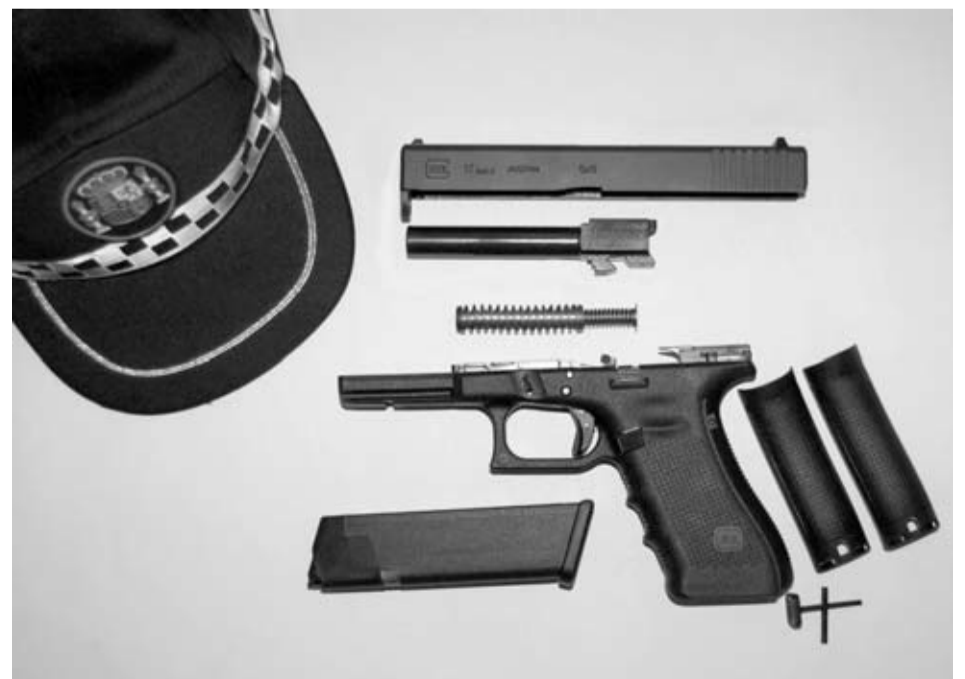
Despiece de la G17 de 4ª Generación. Véase la sencillez de mecanismos y los lomos intercambiables.
