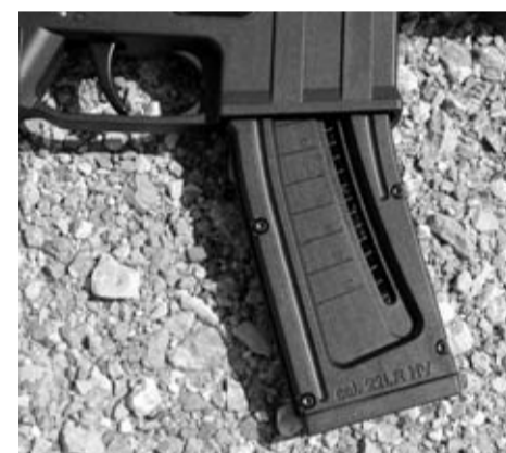
En la imagen superior, la ISSC MK22 con la culata plegada sobre el lado derecho del arma. Abajo, detalle del cargador con capacidad para 22 cartuchos del calibre .22LR.
