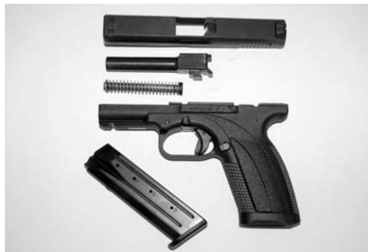
Despiece básico de la pistola CARACAL F. Nótese el grosor de su corredera, el detalle de su muelle recuperador (idéntico al de la Glock de 3ª Generación), y su cargador extraíble con capacidad para 18 cartuchos del calibre 9x19mm.
