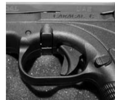
Detalle del disparador tipo "safe Activon" de Glock y del botón que actúa como retén del cargador.
