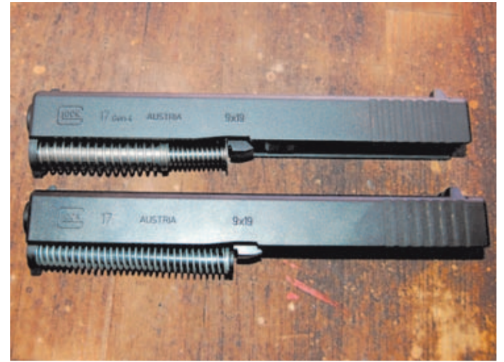
Detalle de las 2 correderas. En la de arriba vemos la inscripción "Gen 4" y el doble muelle. Abajo, la corredera de la 3ª Generación con el muelle simple.
