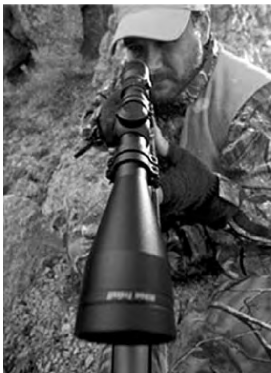
Una campana de gran diámetro (de 40, 50 o 56mm) siempre asegura una buena entrada de luz.
