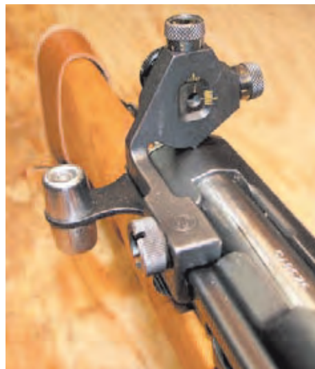
Vista anterior y posterior del clásico diopter del fusil histórico militar suizo Schmidt Rubin K-31.
