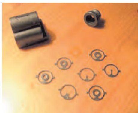
Conjunto de placas intercambiables para diopter. Estas placas metálicas presentan diferentes diseños y orificios de distinto diámetro.
