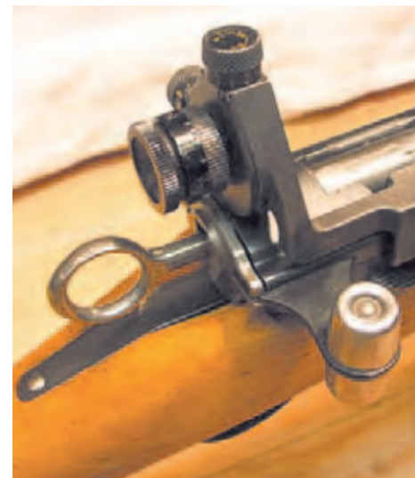
Vista anterior y posterior del clásico diopter del fusil histórico militar suizo Schmidt Rubin K-31.
