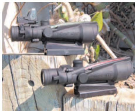
La fibra óptica determina el color de la retícula de cada Trijicon. He aquí uno rojo y uno verde.
