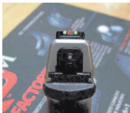
Los tubos de Tritio se pueden combinar de varios colores, como en esta Springfield XD.
