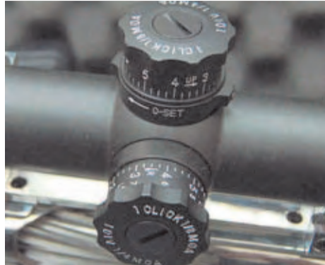
Las torretas de ajuste son fundamentales en estos visores para agilizar en las correcciones.
