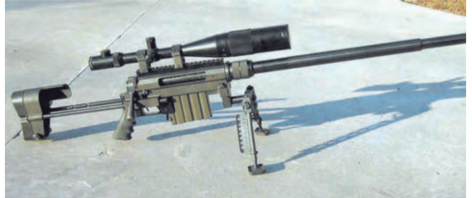
Los rifles de alta precisión, como este espectacular EDM Arms Windrunner modular, siempre van acompañados de visores de grandes aumentos. En este caso, un Nightforce con parasol incluido.
