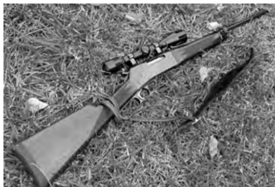
Visor de caza Weaver Classic de 4 aumentos fijos montado sobre un rifle de palanca.
