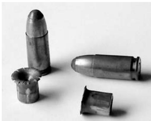
Cartuchos Action-1 de Geco después de realizar la prueba balística. Obsérvese la deformación de su proyectil.
