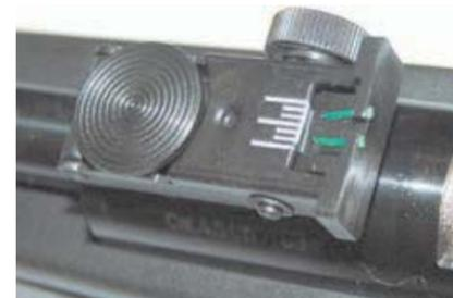
Detalle del alza de acero micrométrica equipada con dos fibras ópticas de color verde.
